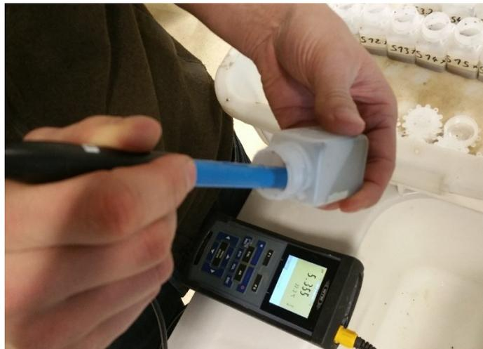
Abbildung 3-11. Messen des pH-Wertes
