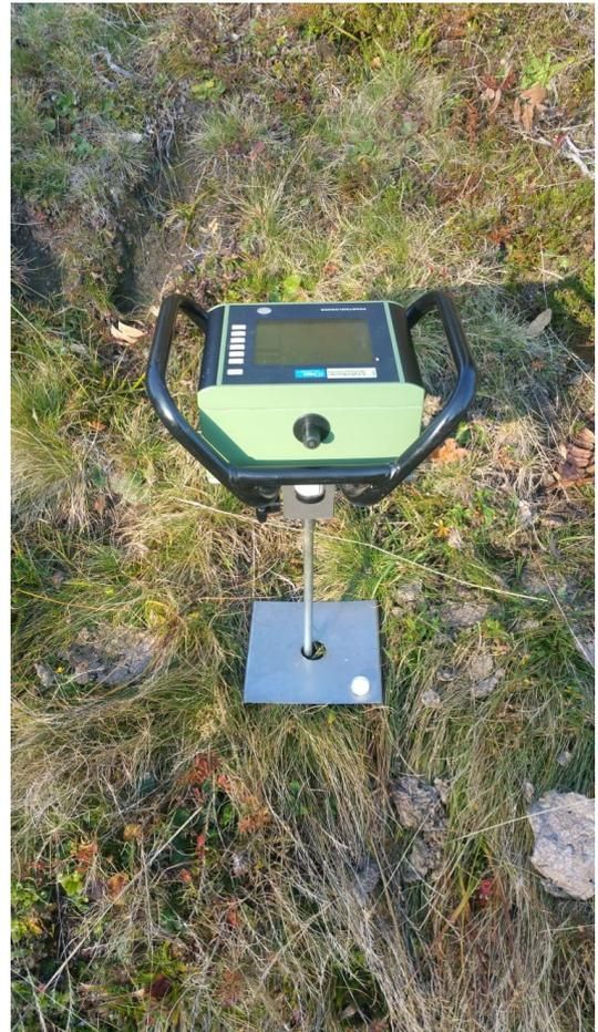
Abbildung 3-9. Ermittlung des Eindringwiderstandes mit dem Penetrologger
