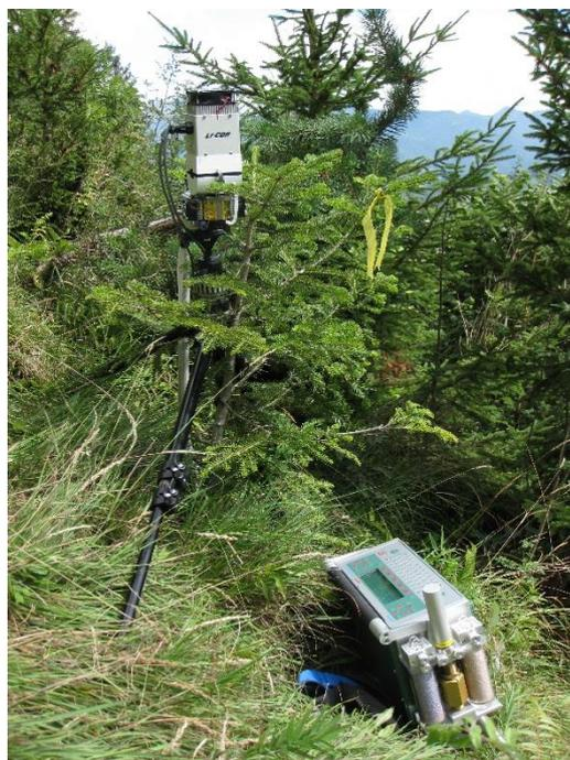
**Abb. 9** Gasaustauschmessung an einer Tanne mit dem LI 6400 der Firma LI-COR Biosciences Inc. Links oben im Bild: Conifer chamber auf Stativ, rechts unten: tragbare Konsole mit CO<sub>2</sub>-Kartusche und Trocknungsmitteln an der bildzugewandten Seite.
