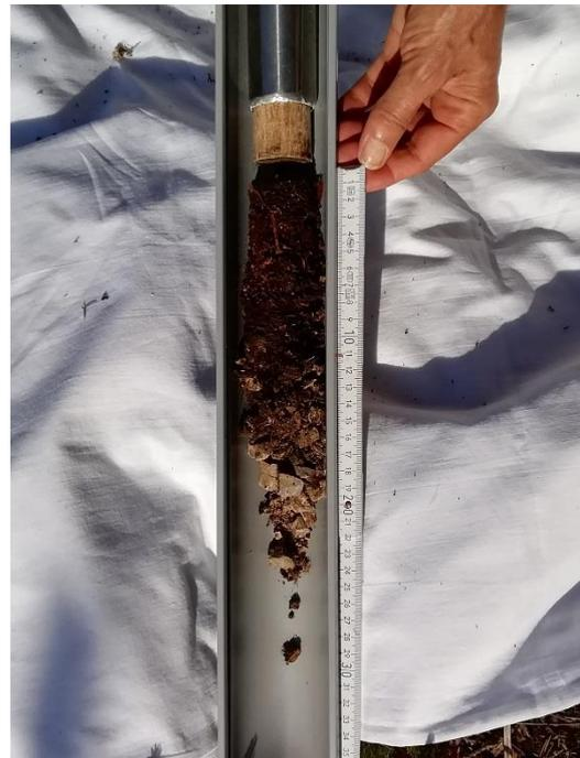
*Abb. 11 Bodenprobenahme mittels Bohrstockmethode nach BOLTE et al. (2003). Links: Einschlagen des Metallrohres. Rechts: geworbene Bodenprobe.*
