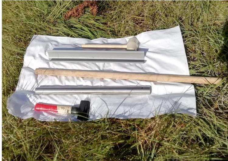
*Abb. 10 Werkzeuge für die Bodenbeprobung (Gummihammer, Kunststoffhalbschale, Holzzylinder, unten angeschliffenes Metallrohr, Fäustel 1kg).*
