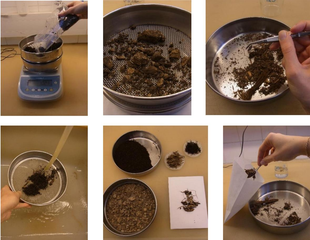
**Abb. 12** Aufbereitung der Bodenproben: 1. Wiegen 2. Sieben 3. Auftrennen der einzelnen Fraktionen 4. Reinigen der Fraktionen 5. Fraktionen im Uhrzeigersinn: Grobboden, Feinboden, Gras-, Baumwurzeln, TOS 6. Wiegen und Aufbewahrung zur Trocknung und weiteren Bearbeitung.
