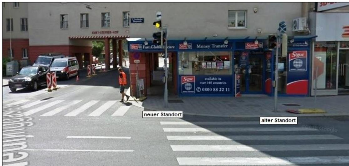
Abbildung 5.1-13: Versetzung des gelben Blinklichts näher zum westlichen Schutzweg, Blickrichtung Westen (Quelle: maps.google.at 2019; bearbeitet)
