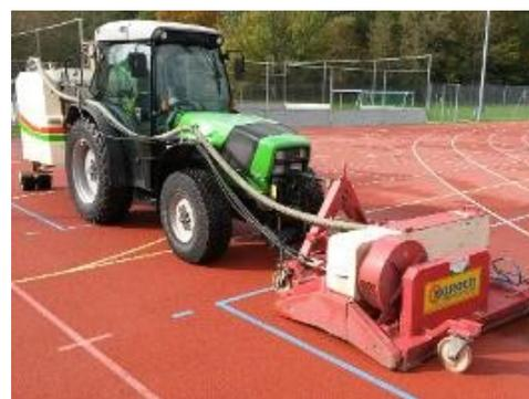
**Abbildung 5: Tiefenreinigungsgerät**
