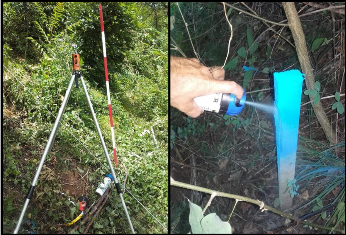
Abbildung 7: Im ersten Foto (v.l.n.r.) erfolgt das Abstecken der Fluchtstäbe, zur Bestimmung der Richtung wird der Wyssenkompass verwendet, für Entfernungsmessungen das Rollmeter. Im zweiten Bild wird der eingeschlagene Pflöck mit blauem Farbspray markiert. (Quelle: Eigene Fotos)
