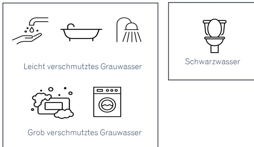
Abbildung 1. Definition Grauwasser und Schwarzwasser (eigene Abbildung)
