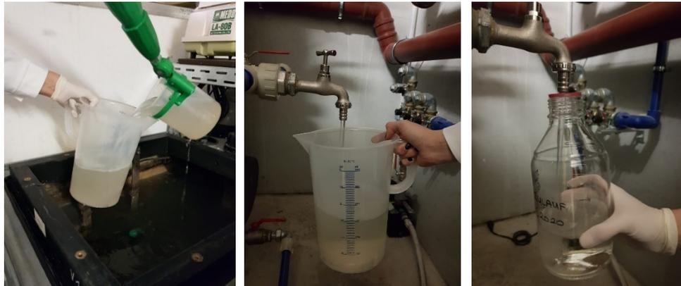
*Abbildung 14. Bild links: Probenentnahme für chemische Analysen am Zulauf; Bild Mitte: Probenentnahme für chemische Analysen am Ablauf; Bild rechts: Probenentnahme für mikrobiologische Analyse am Ablauf (eigene Aufnahmen 2020)*
