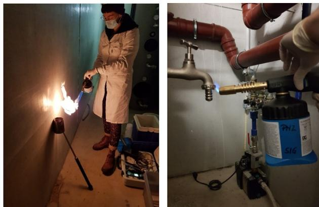
*Abbildung 15. Sterilisation der Instrumente und des Ablaufs für mikrobiologische Analysen (eigene Aufnahmen 2020)*
