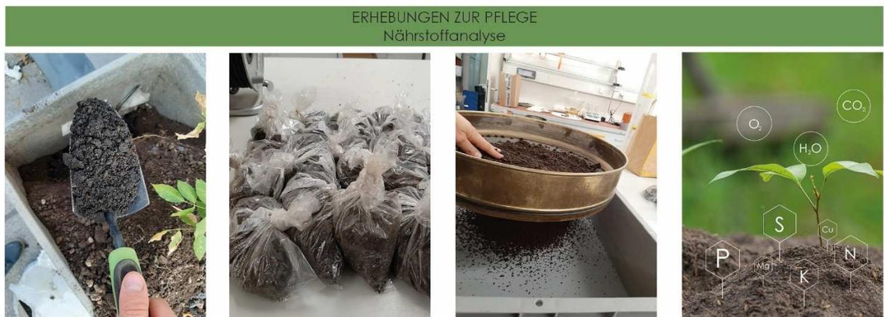
Abb. 25: Entnahme und Vorbereitungen der Substratproben für die Nährstoffanalyse
