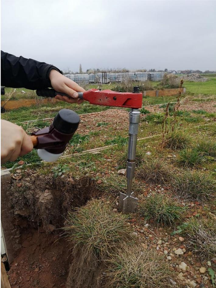
Abbildung 25: Hr. Müller bei der Handhabung der Flügelsonde am Punktsaatbeet (Beet 6), eigene Aufnahme 2019
