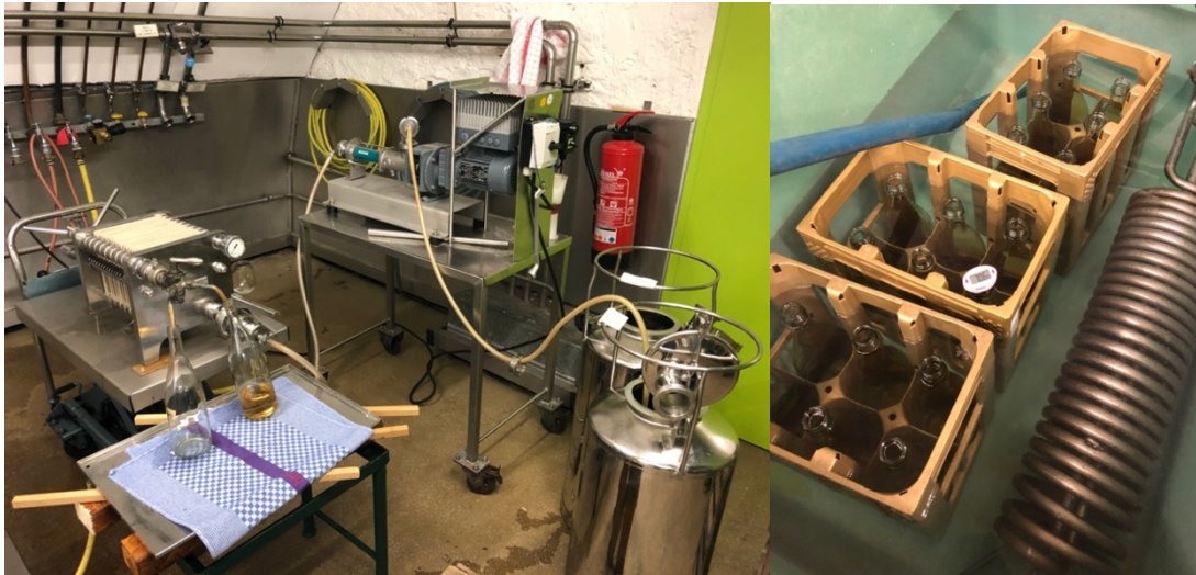
Abbildung 15: Abfüllung des Verjus Abfüllung über Exzentrerschneckenpumpe und Schichtenfilter (links). Erhitzung des Verjus auf 80 °C im Heißwasserbad (rechts). Quelle: eigene Aufnahme vom 19. August 2020
