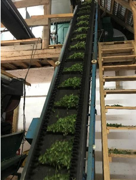
Abbildung 14: zerkleinerte Pfefferminze z. Windsichten nach oben transportiert, eigene Aufnahme
