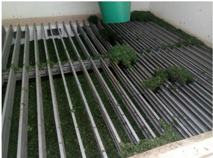
Abbildung 17: Trockengut fällt eine Ebene tiefer, eigene Aufnahme
