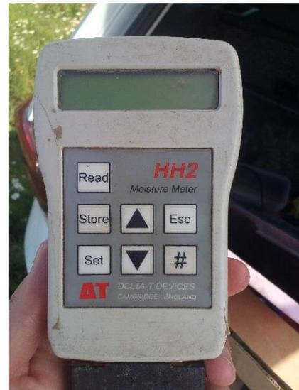
Abbildung 9: Auslese-Gerät der TDR-Sonden, eigene Aufnahme
