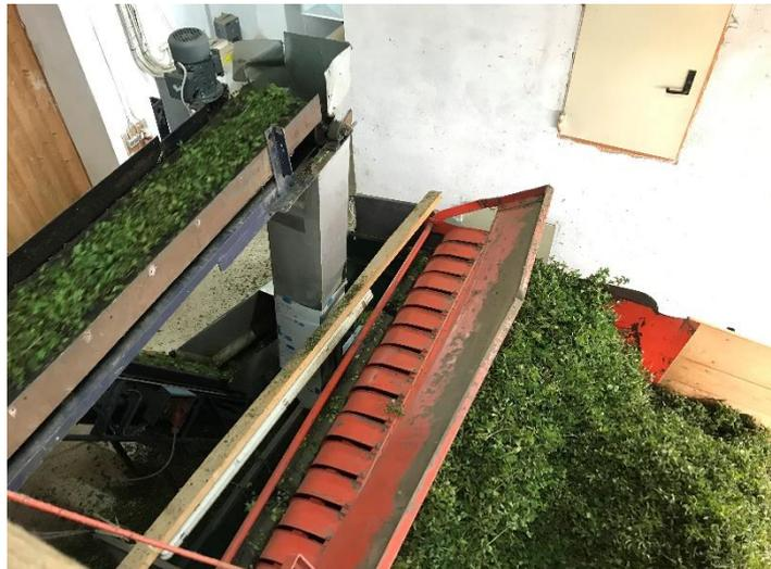
Abbildung 13: Pfefferminze wird angeliefert und zerkleinert, eigene Aufnahme
