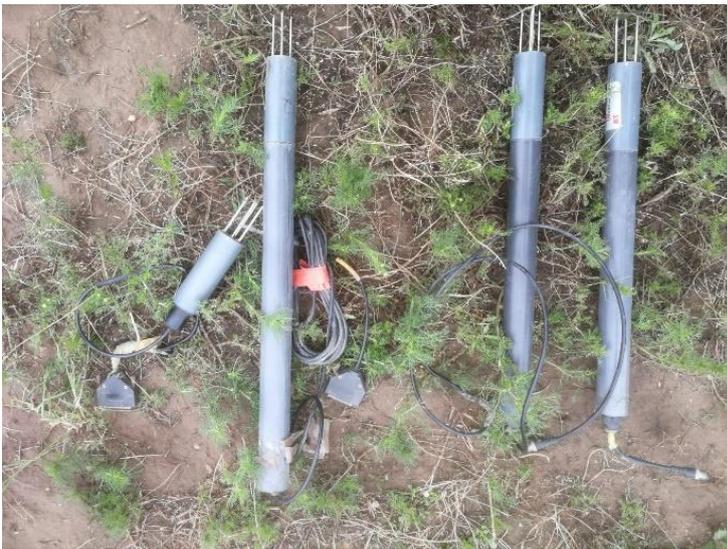
Abbildung 8: TDR-Sonden, verschiedene Größen, eigene Aufnahme
