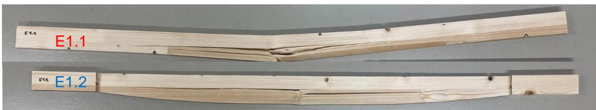
Abbildung 32: Bruchbilder der Referenzprobe E1.1 und der formoptimierten Probe E1.2 der zweiten Versuchsreihe
