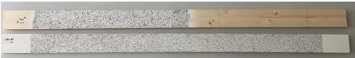
Abbildung 11: Aufgetragenes Muster am Beispiel der Vollquerschnittproben C1.2 mit kleinem FOV und C2.2 mit großem FOV
