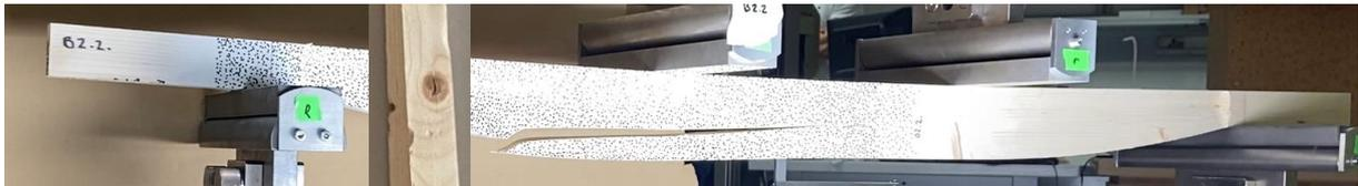
Abbildung 37: Bruchverhalten der formoptimierten Probe B2.2 inklusive eines Ausschnittes der Trägerunterkante mit dem Ast und der verbundenen Faserabweichung
