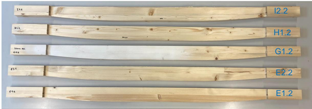
Abbildung 6: Formoptimierte Prüfkörper der zweiten Versuchsreihe
