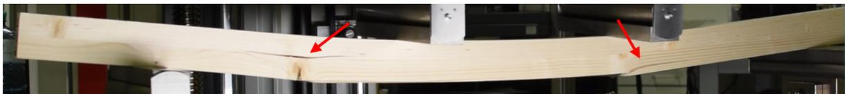
Abbildung 34: Bruchverhalten der Referenzprobe B2.1 mit den beiden Teilbrüchen an der rechten Stelle und im weiteren Prüfverlauf an der linken Stelle
