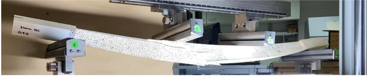
Abbildung 39: Bruchverhalten der formoptimierten Probe G1.2 mit einhergehenden Stabilitätsproblemen
