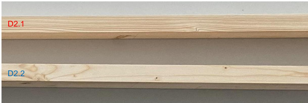
Abbildung 51: erhöhtes Vorkommen von Reaktionsholz bei der Referenzprobe D2.1 im Gegensatz zu der dazugehörigen optimierten- bzw. Vollquerschnittprobe D2.2
