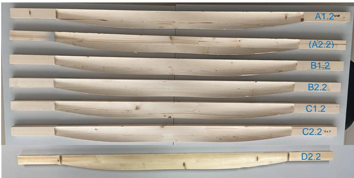
Abbildung 5: Formoptimierte Prüfkörper für die erste Versuchsreihe inklusive der nicht verwendeten Probe A2.2
