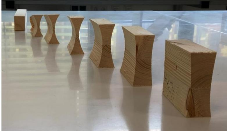
Abbildung 7: Ermittlung der Geometrie-Abweichung durch die CNC-Bearbeitung auf einem halben Träger, der in sieben Stücke geteilt wurde
