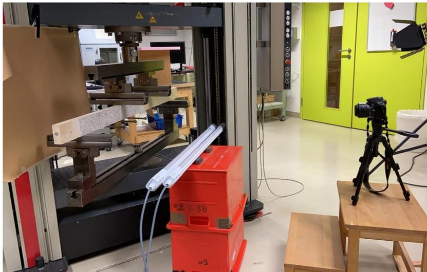
Abbildung 13: Prüfaufbau für die digitale Bildkorrelation inklusiver Belichtung, Hintergrund, Stativ und Kamera
