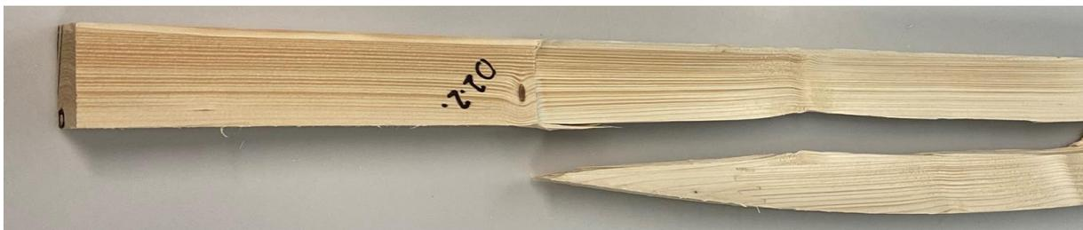
Abbildung 48: Ausbildung des Auflagerbereiches und damit einhergehende Problematik, dass aufgrund des abrupten Übergangs Spannungsspitzen entstehen können (hier gezeigt an der formoptimierten Probe D2.2)
