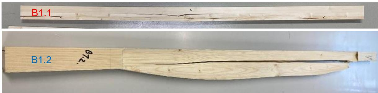
Abbildung 32: Bruchbilder der Referenzprobe B1.1 und der formoptimierten Probe B1.2 der ersten Versuchsreihe
