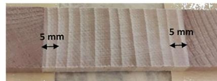
**Abbildung 12: Prüfkörper quer zur Faser (RT)**
