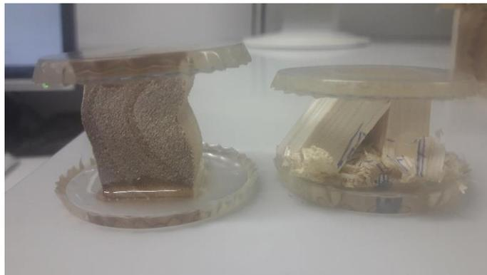
**Abbildung 43: Nach der Prüfung quer (links) und längs (rechts) zur Faser**
