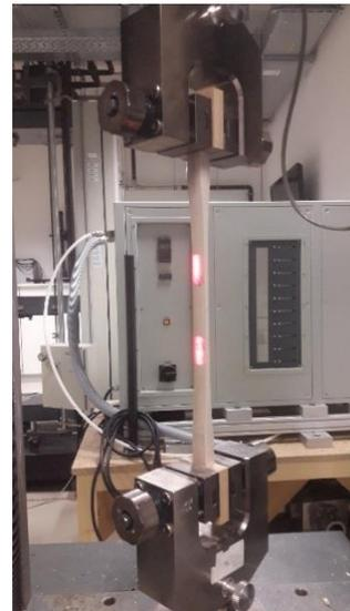
**Abbildung 16: Längszug Prüfung Festigkeit und E-Modul**
