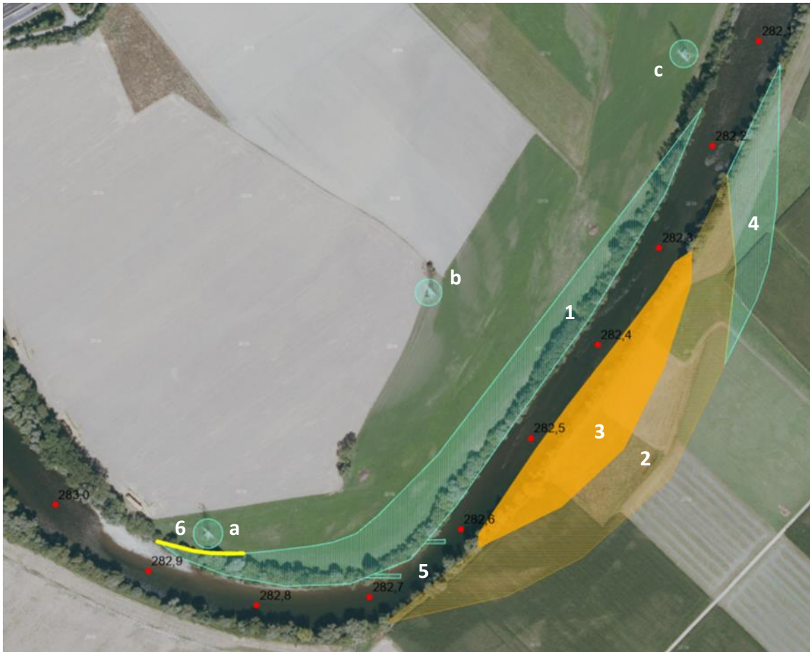
Abbildung 42: Abschnitt Mur bei St. Stefan mit schematischer Einzeichnung möglicher Maßnahmen; dynamische Maßnahmen in türkis und gestaltende Maßnahmen in orange (Grundlage: Orthofoto 2019, Geoland Basemap)
