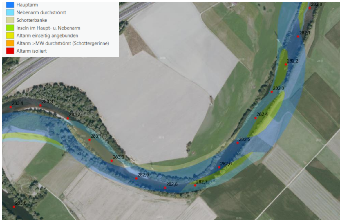
Abbildung 40: Abschnitt Mur bei St. Stefan mit dem Zustand der Mur 1812 überlagert (Grundlage: Orthofoto 2019, Geoland Basemap)
