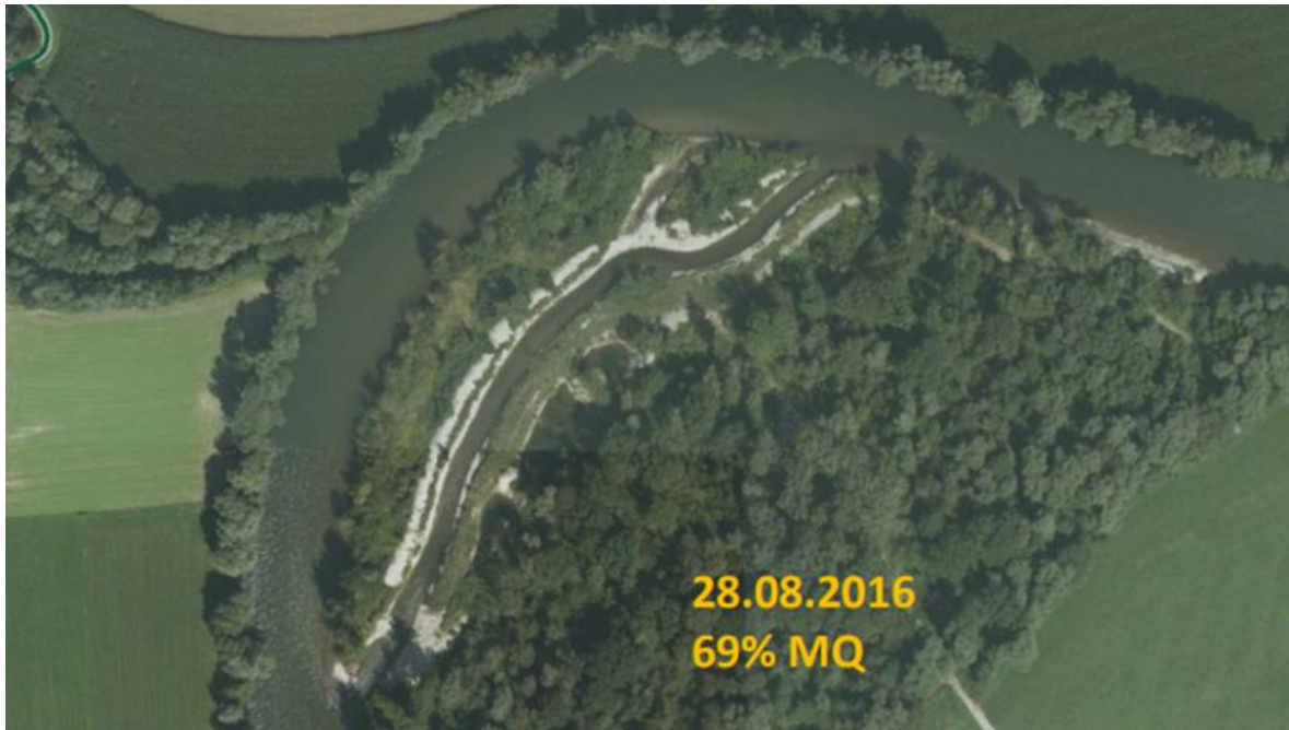
Abbildung 18: Luftaufnahme bei Feistritz nach Fertigstellung der LIFE+ Maßnahme 2016; aufgenommen am 28.08.2016, bei 69% des langjährigen mittleren Abflusses (Google Earth, Pegelmessstelle Zeltweg)
