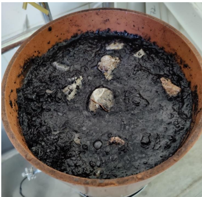
Abbildung 136: FS2_15 - Wasserrückstau nach den Einschlämmvorgängen
