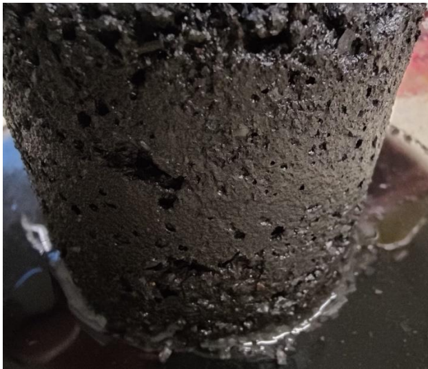
Abbildung 114: FS2_V_ges – erster ausgebauter Probenkörper mit stellenweise sichtbaren Lufteinschlüssen
