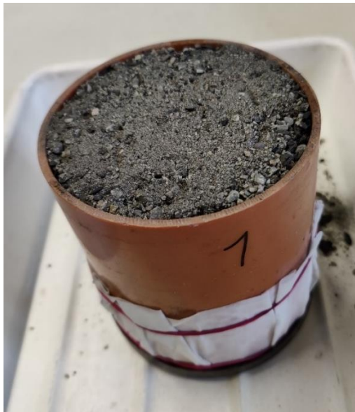
Abbildung 69: FS1_UV_It - lufttrockener Einbau der FS1-Mischung
