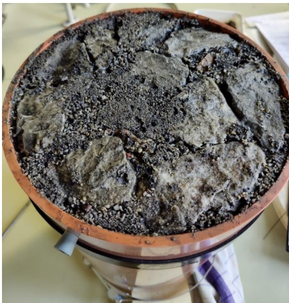
Abbildung 118: FS1_25 - Unterseite einer mit 25 Vol.-% FS1 eingeschlämmten Probe
