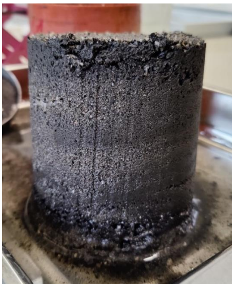
Abbildung 91: FS1_SCHLÄMM - Schichtenbildung im Probenkörper entstanden durch den „Durchschlammvorgang“
