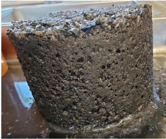
Abbildung 84: FS1_V_hges - sichtbare Lufteinschlüsse nach Ausbau der Probe
