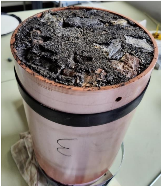
Abbildung 131: FS1_15 - Unterseite einer mit 15 Vol.-% eingeschlammten Probe
