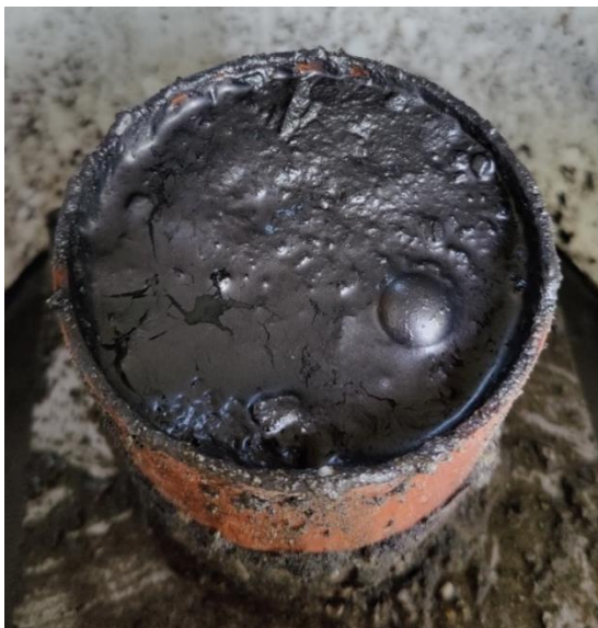
Abbildung 89: FS1_SCHLÄMM - Probenzylinder direkt nach dem „Durchschlammvorgang“ mit aufschwimmender Pflanzenkohle
