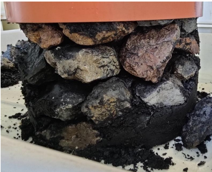
Abbildung 140: FS2_15 - große Bereiche ohne Feinsubstrat
