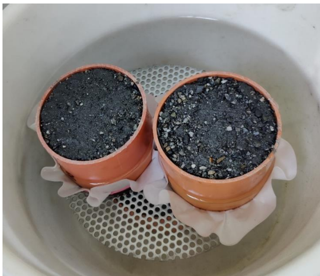
Abbildung 70: FS1_UV_It - sättigen der lufttrocken eingebauten Proben
