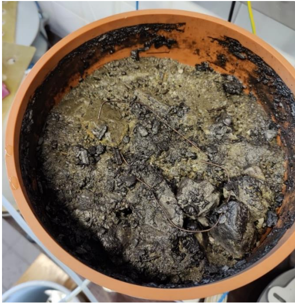
Abbildung 117: FS1_25 - Zustand einer Probe direkt nach dem Einschlämmen mit deutlich sichtbarem Feinsubstrat an der Oberfläche
