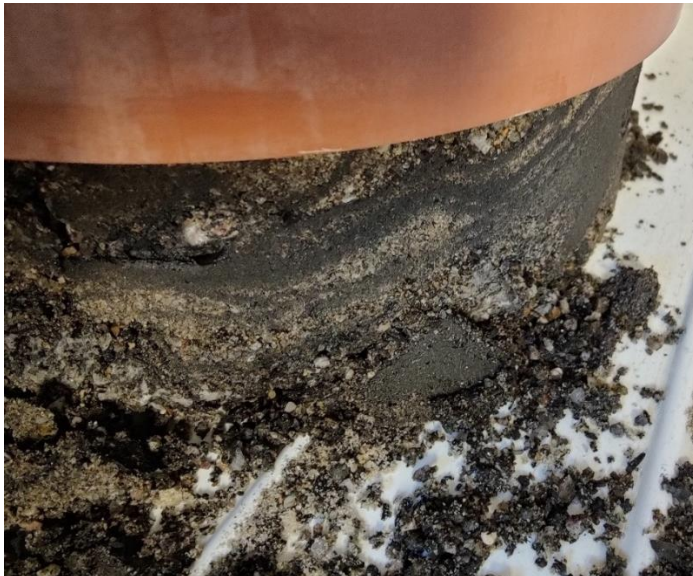
Abbildung 120: FS1_25 – weitere sichtbare Schichtenbildung beim Probenausbau
