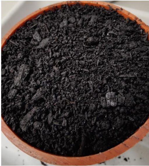
Abbildung 107: FS2_V_hges - halb gesättigt eingebaute FS2-Mischung vor dem Verdichten
