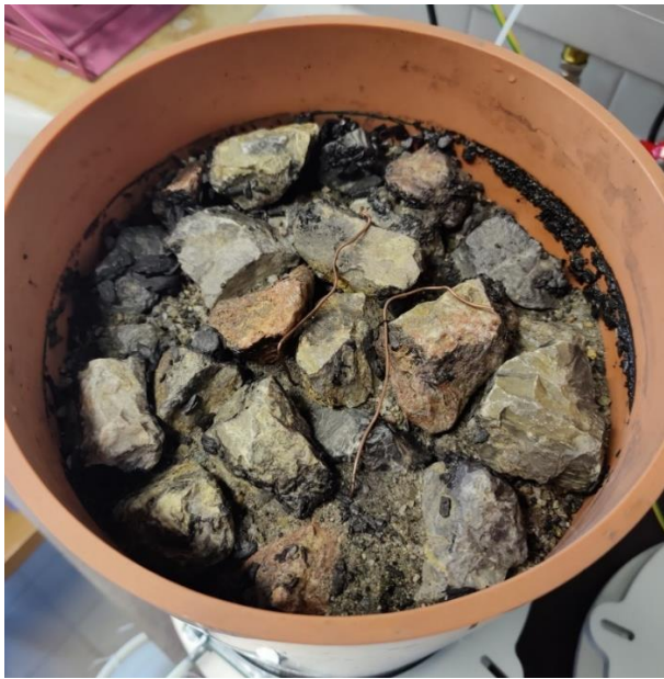
Abbildung 125: FS1_20 - eine Probe nach dem Einschlämmen von 20 Vol.-% der FS1-Mischung
