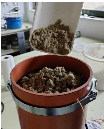
Abbildung 46: Einbau des Sands
