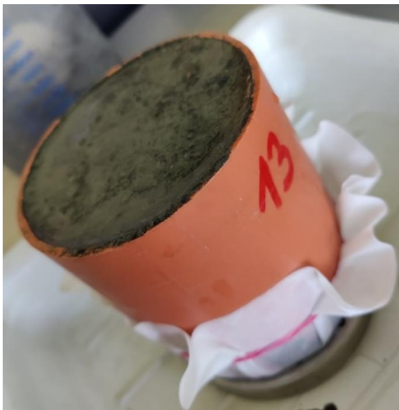
Abbildung 77: FS1_UV_üges - übersättigte FS1-Mischung direkt nach dem Einbau
