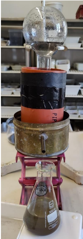
Abbildung 104: FS2_UV_üges - leicht verfärbtes Wasser bei Bestimmung der gesättigten hydraulischen Leitfähigkeit
