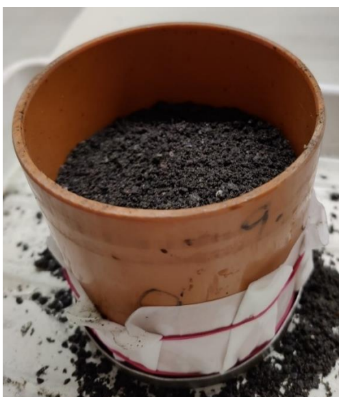
Abbildung 83: FS1_V_hges - deutliche Setzungen der halb gesättigt eingebauten FS1-Mischung nach der moderaten Verdichtung
