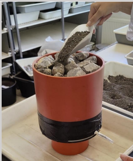
Abbildung 31: Einfüllen des Feinsubstrats
