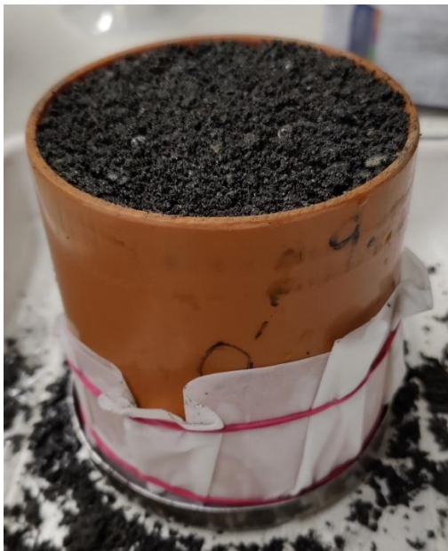
Abbildung 82: FS1_V_hges - halb gesättigt eingebaute FS1-Mischung vor der moderaten Verdichtung
