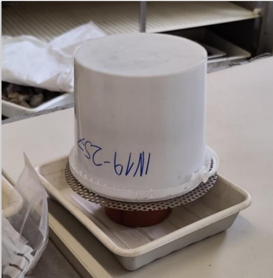
Abbildung 23: Plastikbecher als Verdunstungsschutz während der Bestimmung der WK 2h
