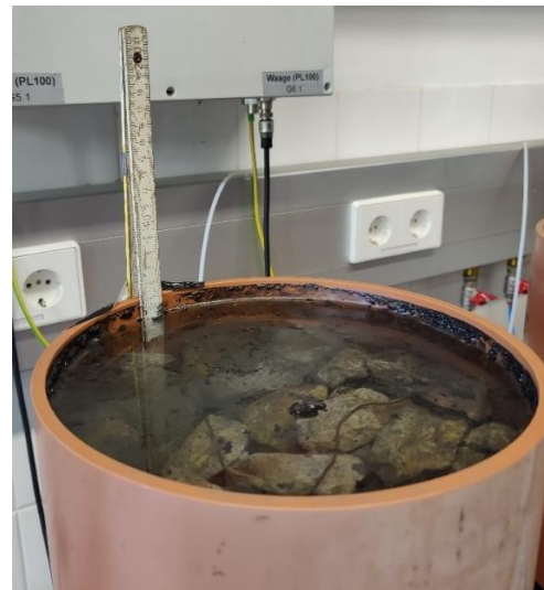
Abbildung 41: Bestimmung der gesättigten hydraulischen Leitfähigkeit
