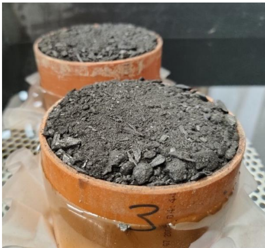
Abbildung 93: FS2_UV_It - Hebungen der lufttrockenen FS2-Mischung während des Sättigungsvorgangs
