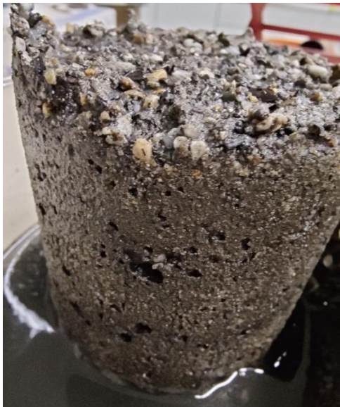
Abbildung 87: FS1_V_ges – erster Probenkörper der gesättigt eingebauten FS1-Mischung mit moderater Verdichtung nach dem Ausbau mit sichtbaren Lufteinschlüssen
