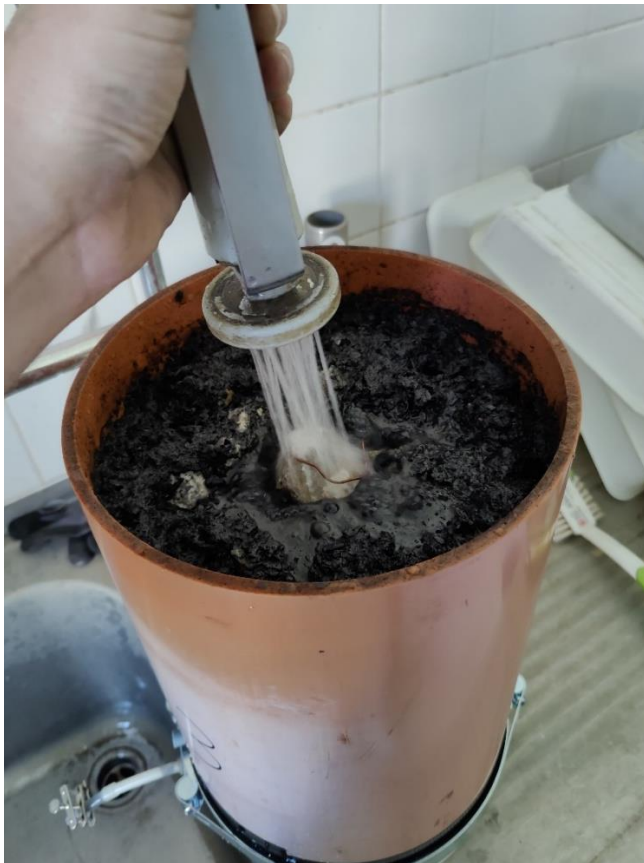
Abbildung 135: FS2_15 - Einschlämmen mittels Brausekopfs
