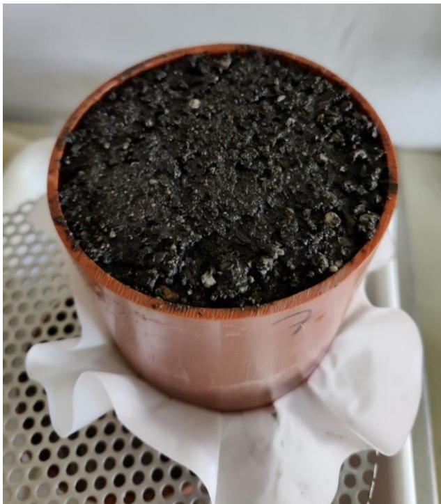
Abbildung 75: FS1_UV_ges - Einbau der gesättigten FS1-Mischung
