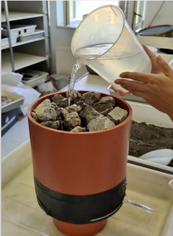
Abbildung 32: Einschlämmen des Feinsubstrats
