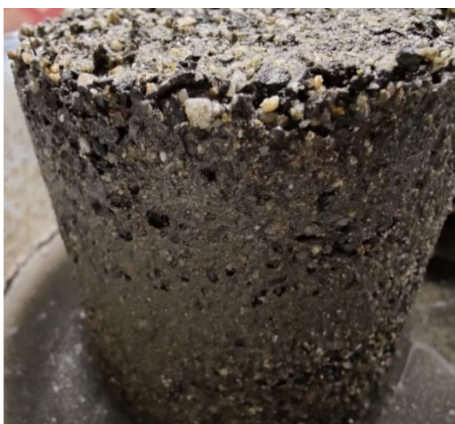
Abbildung 81: FS1_V_It - zweiter Probenkörper mit etwas mehr sichtbaren Lufteinschlüssen
