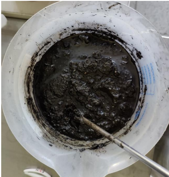
Abbildung 74: FS1_UV_ges - FS1 gesättigt vor dem Einbau in die Probenzylinder
