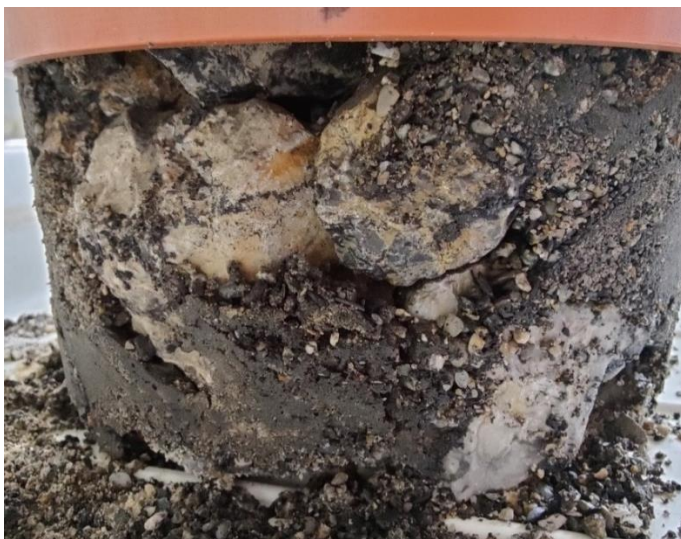
Abbildung 123: FS1_25 - größere Bereiche ohne Feinsubstrat
