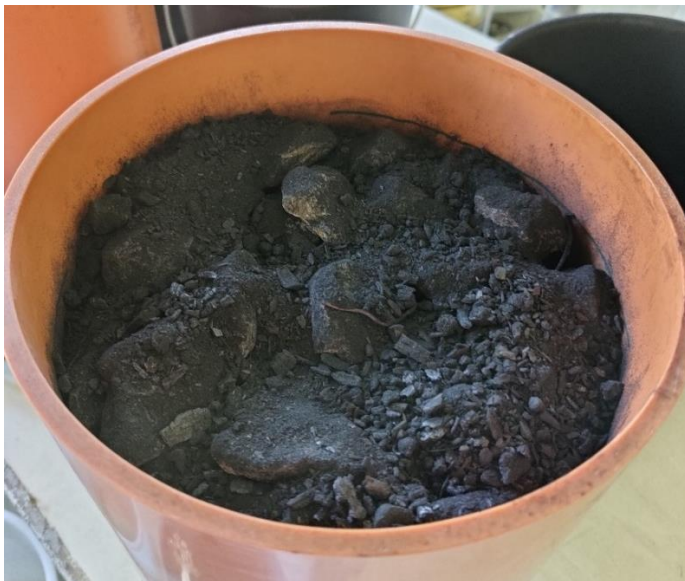
Abbildung 134: FS2_15 – eine Probe nach dem Einfüllen der lufttrockenen FS2-Mischung
