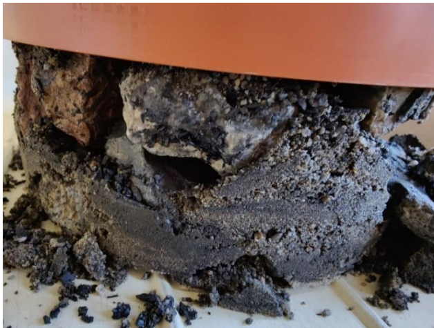
Abbildung 132: FS1_15 - zum Teil große Hohlräume ohne Feinsubstrat
