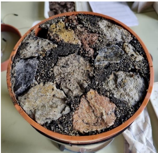
Abbildung 44: Freigelegte Unterseite des Schwammstadtsubstrats
