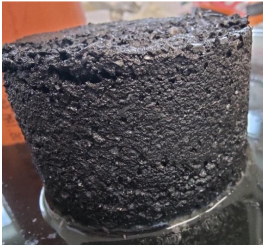
Abbildung 110: FS2_V_hges - halb gesättigt eingebaute und moderat verdichtete FS2-Mischung nach dem Ausbau
