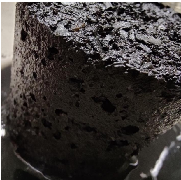
Abbildung 115: FS2_V_ges - zweiter ausgebauter Probenkörper mit sichtbaren Lufteinschlüssen
