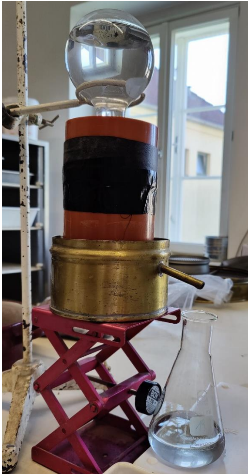
Abbildung 101: FS2_UV_ges - klares austretendes Wasser bei Messung der gesättigten hydraulischen Leitfähigkeit bei gesättigt eingebauter Feinsubstratmischung FS2
