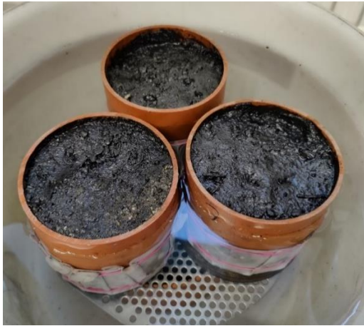
Abbildung 90: FS1_SCHLÄMM - Probenzylinder der „durchgeschlämmten“ FS1-Mischung während des Sättigungsvorgangs
