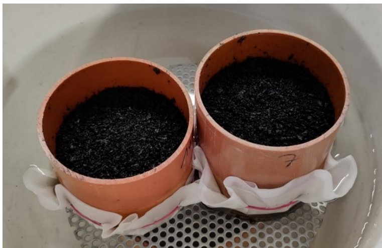
Abbildung 96: FS2_UV_hges - deutliche Setzungen von FS2_hges im Zuge der Sättigung
