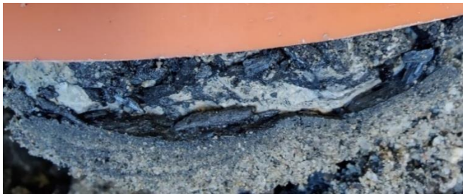
Abbildung 122: FS1_25 - Hohlraum mit sandigem Material im unteren Bereich und größeren Kohlepartikeln im oberen Bereich
