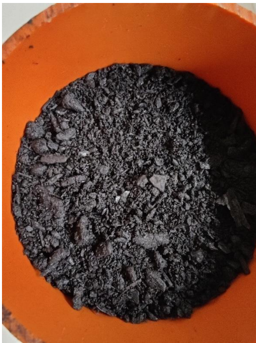
Abbildung 108: FS2_V_hges - deutliche Setzungen der halb gesättigt eingebauten FS2-Mischung nach moderater Verdichtung
