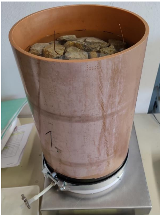
Abbildung 116: FS1_25 - Bestimmung des Grobschlag-Porenvolumens
