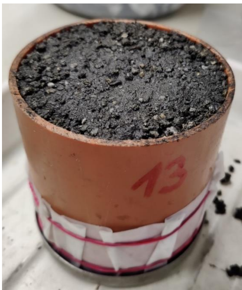
Abbildung 85: FS1_V_ges - gesättigt eingebaute FS1-Mischung vor der Verdichtung
