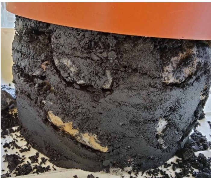
Abbildung 141: FS2_15 - Bereiche im Probenkörper mit mehr Feinsubstrat
