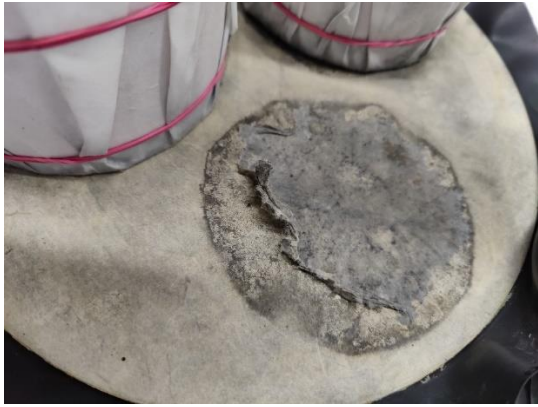
Abbildung 109: FS2_V_hges - Auflösungserscheinungen des Faltenfilters nach Bestimmung der FK
