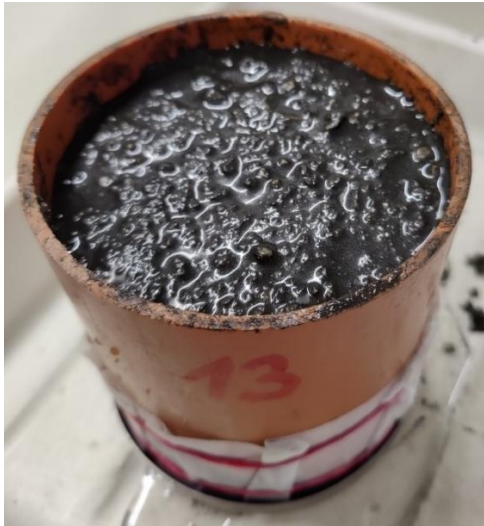
Abbildung 86: FS1_V_ges - gesättigt eingebaute FS1-Mischung nach moderater Verdichtung
