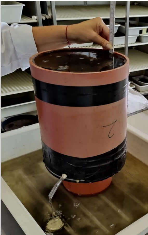
Abbildung 33: Bestimmung der gesättigten hydraulischen Leitfähigkeit des Schwammstadtsubstrats
