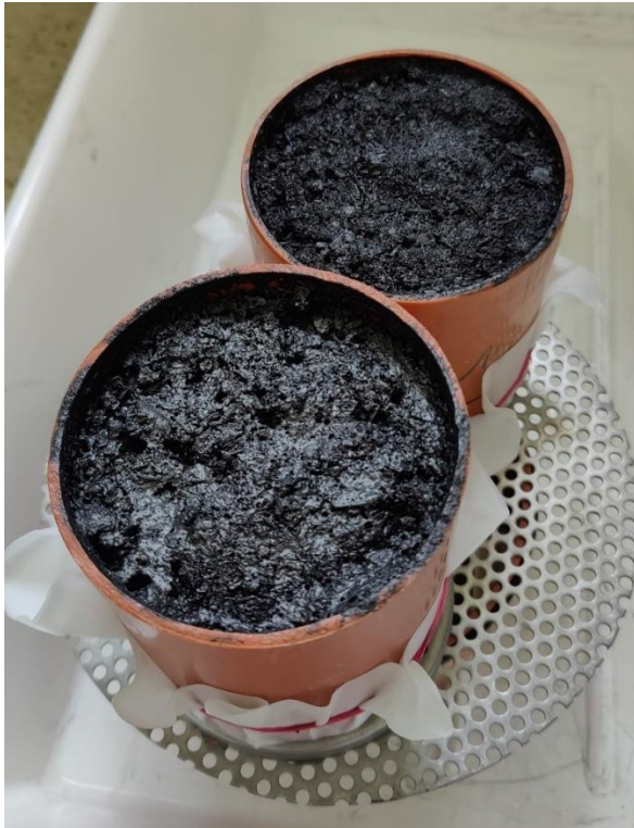
Abbildung 78: FS1_UV_üges - oberflächige Ansammlung der organischen Komponenten bei der übersättigten Variante
