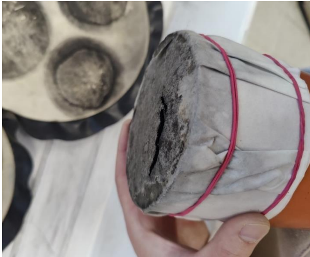
Abbildung 113: FS2_V_ges - Rissbildung des Faltenfilters nach Bestimmung der FK
