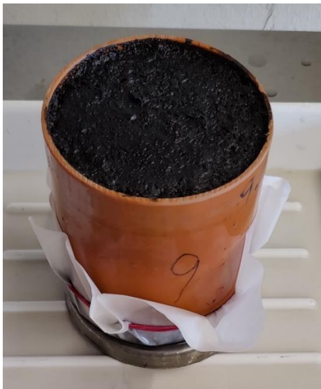
Abbildung 99: FS2_UV_ges - FS2-Mischung gesättigt direkt nach dem Einbau
