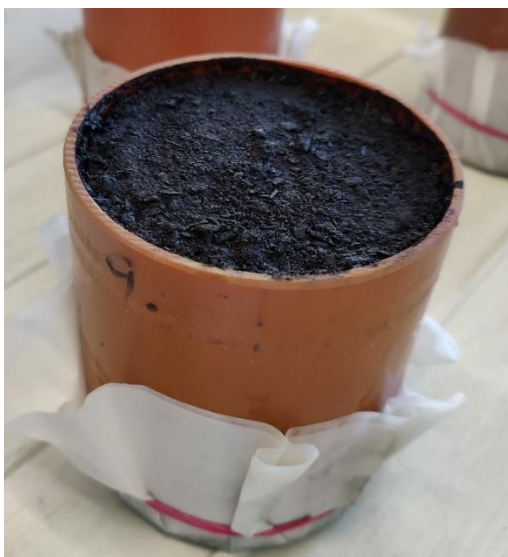
Abbildung 100: FS2_UV_ges - FS2-Mischung gesättigt eingebaut nach Bestimmung der FK
