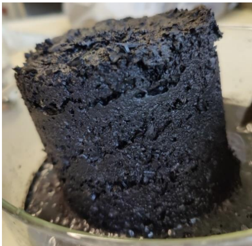
Abbildung 105: FS2_UV_üges - übersättigt eingebaute FS2-Mischung nach dem Ausbau aus dem Probenzylinder
