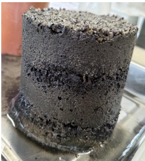
Abbildung 92: FS1_SCHLÄMM - Schichtenbildung einer weiteren Probe der „durchgeschlämmt“ eingebauten FS1-Mischung
