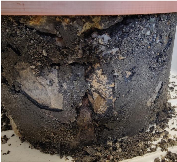
Abbildung 128: FS1_20 - größere Bereiche ohne Feinsubstrat
