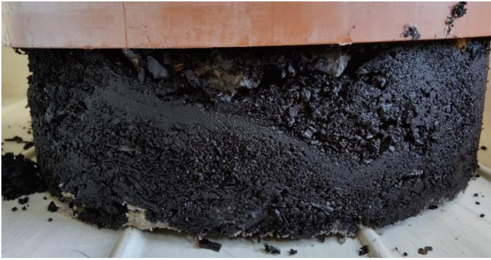
Abbildung 139: FS2_15 - Erkennbare Schichtenbildung mit unterschiedlicher Partikelgröße
