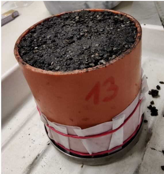
Abbildung 36: Aufbau zur Durchführung der moderaten Verdichtung
