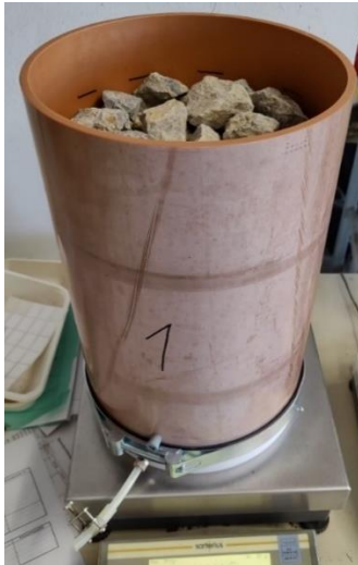
Abbildung 38: Versuchsaufbau zur Untersuchung des Schwammstadtsubstrats
