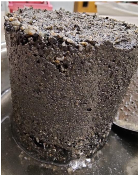
Abbildung 80: FS1_V_It - Probenkörper nach dem Ausbau mit wenigen sichtbaren Lufteinschlüssen
