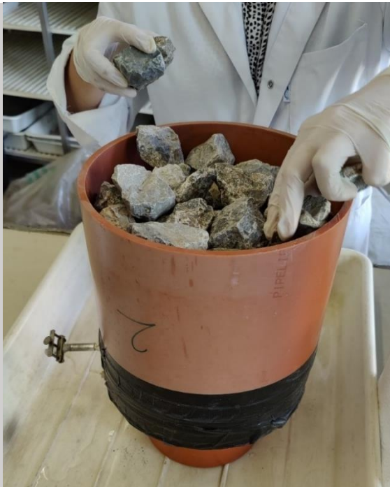
Abbildung 30: Einbringen des Grobschlags in den Probezylinder
