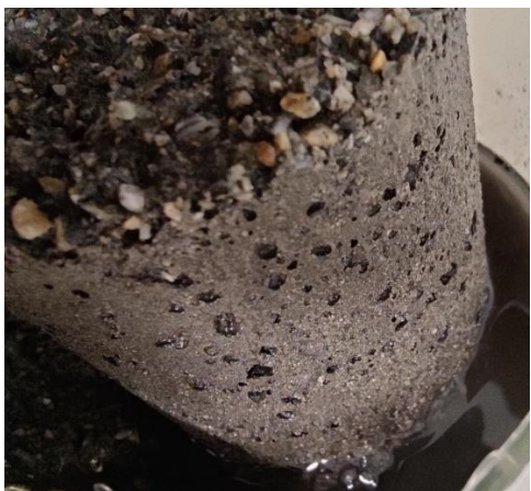
Abbildung 88: FS1_V_ges - zweiter Probenkörper der gesättigt eingebauten FS1-Mischung mit moderater Verdichtung nach dem Ausbau mit sichtbaren Lufteinschlüssen
