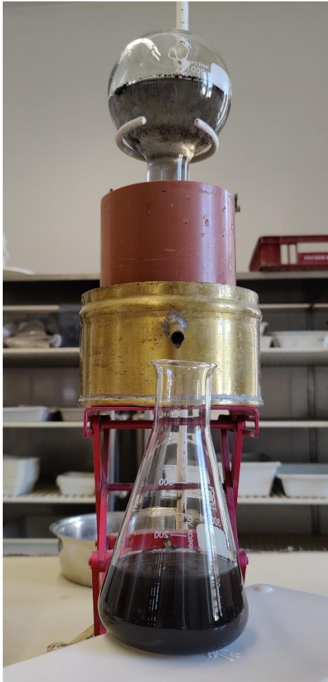
Abbildung 97: FS2_UV_hges - deutliche Verfärbung des austretenden Wassers bei Bestimmung der gesättigten hydraulischen Leitfähigkeit
