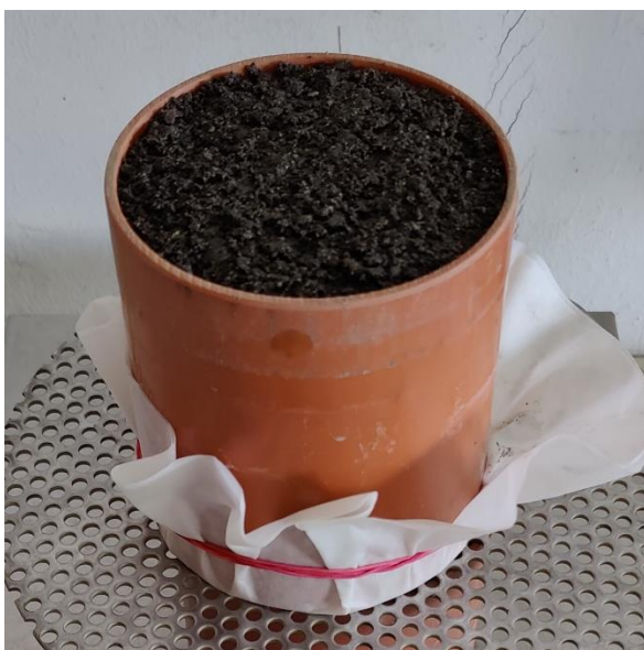
Abbildung 72: FS1_UV_hges - halb gesättigte Mischung FS1 nach dem Einbau
