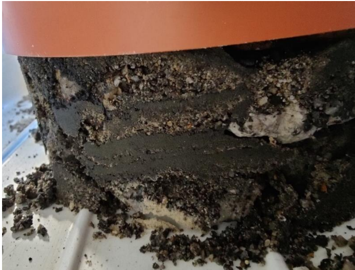
Abbildung 119: FS1_25 - Erkennbare Schichtenbildung beim Probenausbau
