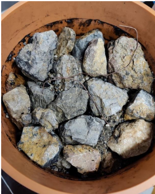
Abbildung 130: FS1_15 - kaum sichtbares Feinsubstrat an der Substratoberfläche nach dem Einschlammvorgang
