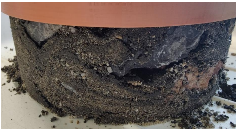
Abbildung 127: FS1_20 - erkennbare Schichtenbildung sowie Hohlräume ohne Feinsubstrat beim Probenausbau
