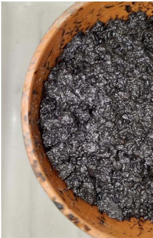
Abbildung 112: FS2_V_ges - Spaltenbildung zwischen Zylinderinnenwand und Probenkörper nach moderater Verdichtung
