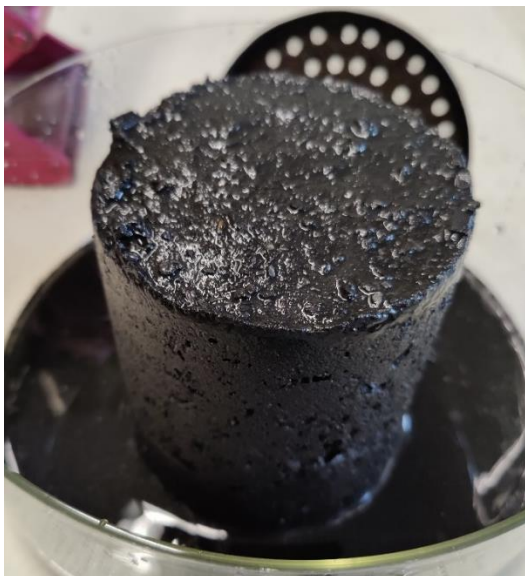
Abbildung 102: FS2_UV_ges - gesättigt eingebaute FS2-Mischung direkt nach dem Ausbau aus dem Probenzylinder
