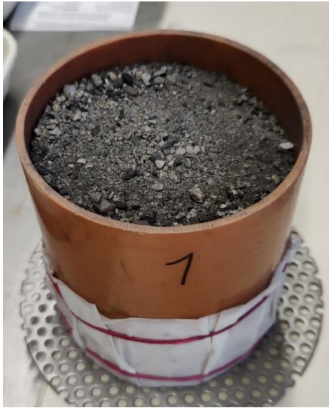
Abbildung 79: FS1_V_It - Setzungen der lufttrocken eingebauten FS1-Mischung nach moderater Verdichtung
