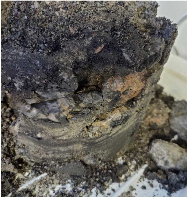
Abbildung 121: FS1_25 - Schichtenbildung im unteren Bereich einer ausgebauten Probe, einige nicht mit Feinsubstrat gefüllte Bereiche in der Mitte und höherer Kohleanteil im oberen Bereich
