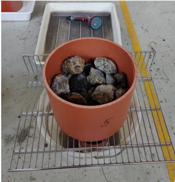
Abbildung 37: Versuchsaufbau zur Durchführung des „Durchschlämmens“
