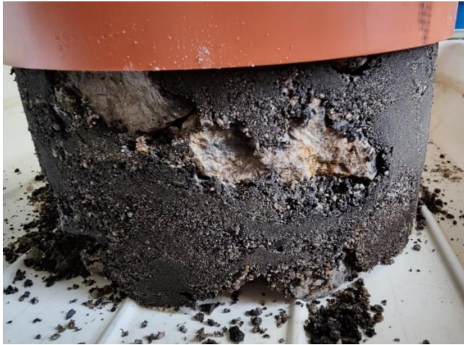
Abbildung 124: FS1_25 - augenscheinlich dichtes Feinsubstrat im unteren Bereich einer Probe mit größeren Hohlräumen dazwischen
