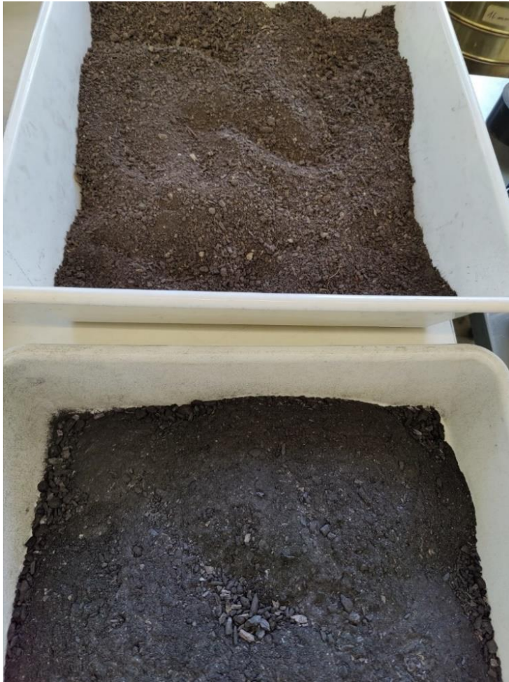
Abbildung 35: Separate Bestandteile der Feinsubstratmischung FS2 (oben Kompost, unten Pflanzenkohle)
