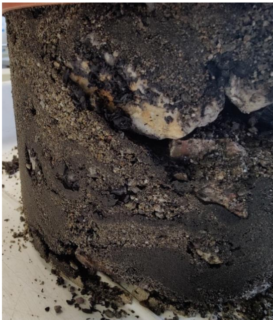
Abbildung 129: FS1_20 - Bereiche mit reichlich Feinsubstrat mit teilweiser Schichtenbildung, sowie Hohlräume mit ausschließlich größeren Kohlepartikeln
