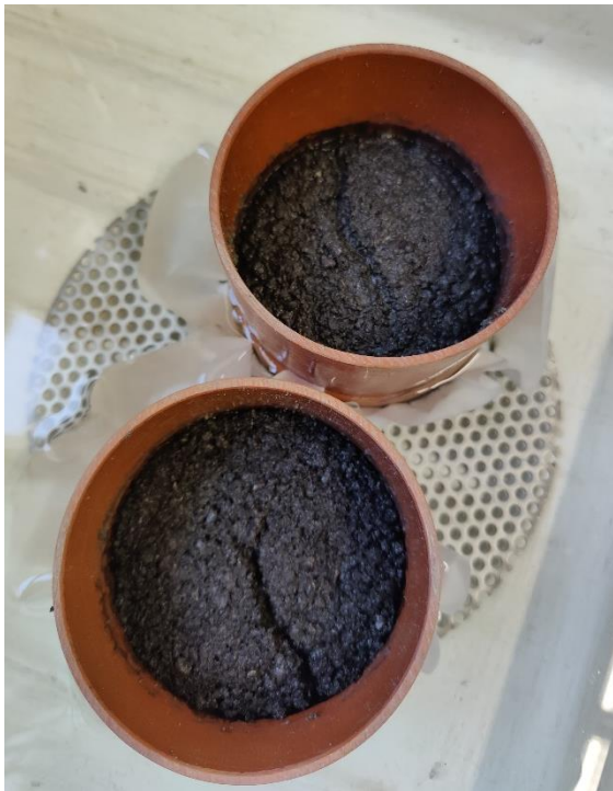
Abbildung 73: FS1_UV_hges - deutliche Setzungen und Risse der halb gesättigt eingebauten FS1-Mischung nach dem Sättigungsvorgang
