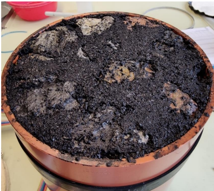
Abbildung 138: FS2_15 - Unterseite des mit Feinsubstratmischung FS2 eingeschlämmten Schwammstadtsubstrats
