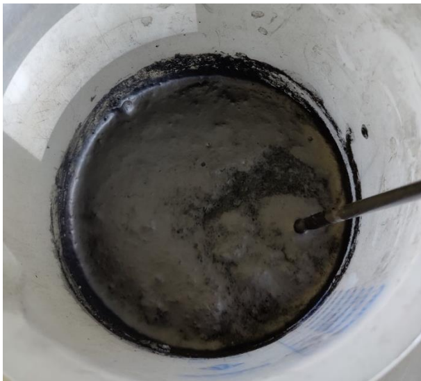
Abbildung 76: FS1_UV_üges - übersättigte FS1-Mischung vor dem Einbau
