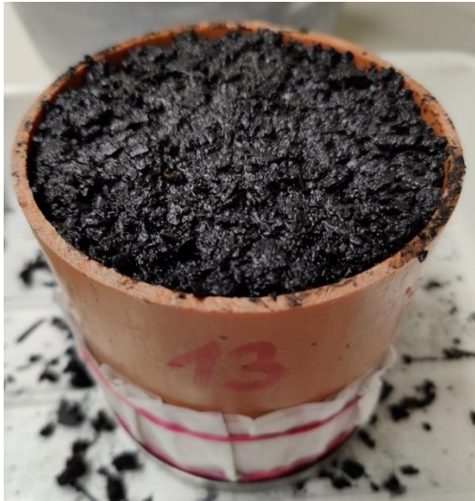
Abbildung 111: FS2_V_ges - gesättigt eingebaute FS2-Mischung vor dem Verdichten
