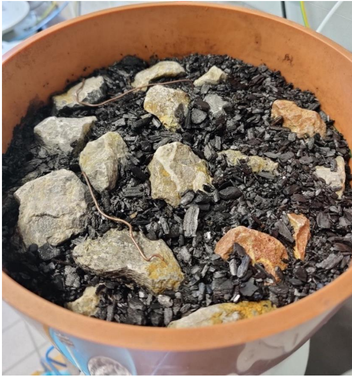
Abbildung 137: FS2_15 - Probenoberfläche nach dem Einschlämmen
