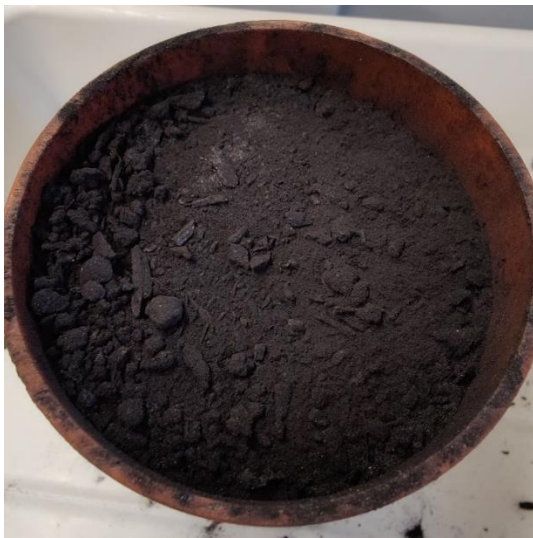
Abbildung 106: FS2_V_It - Setzungen der lufttrocken eingebauten FS2-Mischung nach moderater Verdichtung
