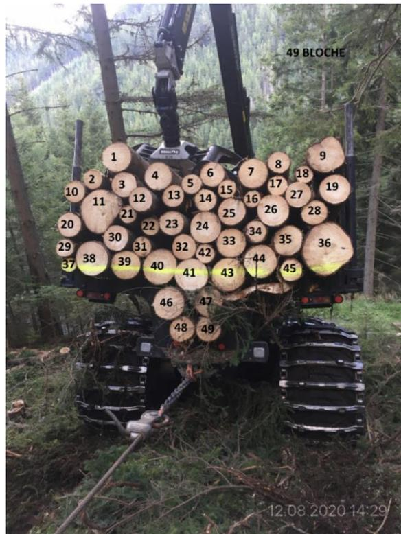
Abbildung 16 : Stirnflächenverfahren am Rungenkorb (Foto: Verfasser)
