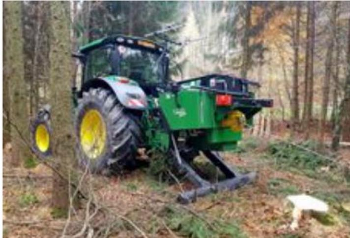
**Abbildung 3: Dreipunktbauwinde (HAAS- Maschinenbau, 2019)**
