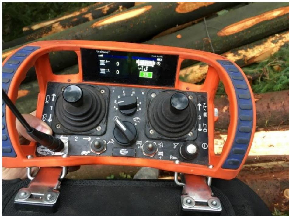
Abbildung 8: Funkfernsteuerung der T-WINCH 10.2 (Foto: Verfasser)
