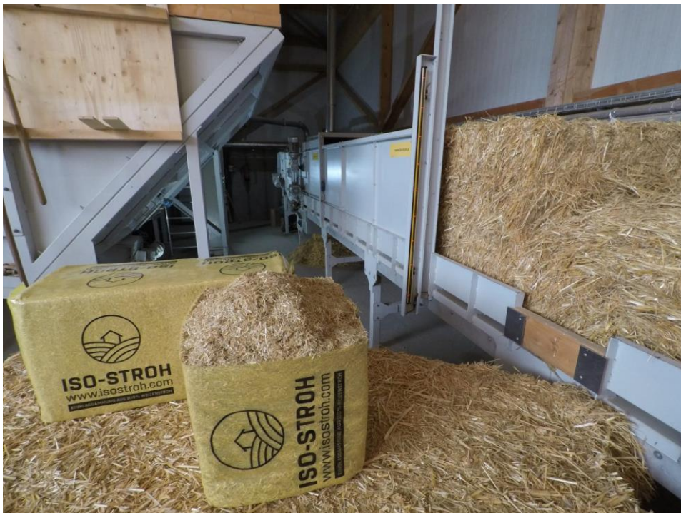
Abbildung 7: Fertiger Stroheinblasdämmstoff in aufgeschnittener Verpackungseinheit, im Hintergrund Produktionsanlage (Stenzel, 2021, pers. comm.)
