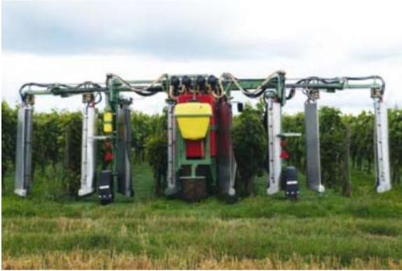
Abbildung 6 Gebläse-Recyclingverfahren, Quelle: Keichler et al. 2019
