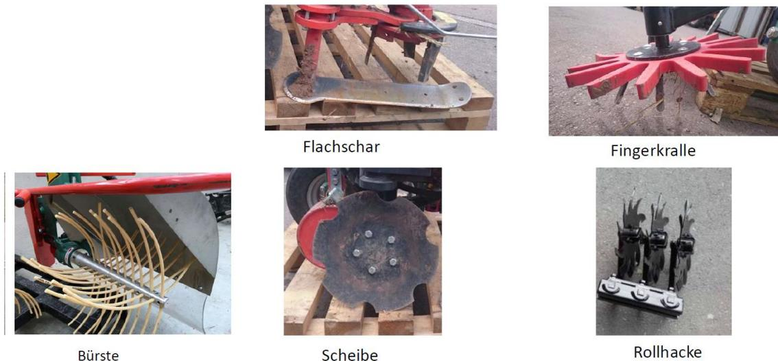
Abbildung 11 Maschinen zur mechanischen Beikrautregulierung im Weinbau (Fischer 2020)
