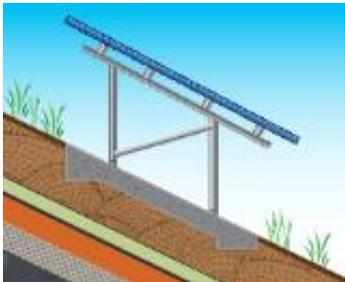
Abbildung 14: Streifenfundament (Quelle: MKULNV NRW 2014, 11)
