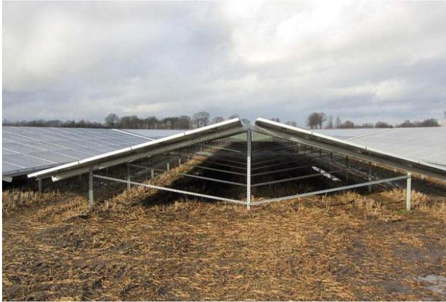
Abbildung 17: Module mit Ost- West Ausrichtung in der Freifläche (Quelle: energykonzept.net o.j.)
