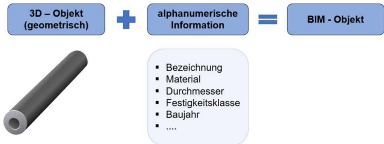
Abbildung 11 Zusammensetzung eines BIM-Objektes aus geometrischer und alphanumerischer Information (Eigene Darstellung)
