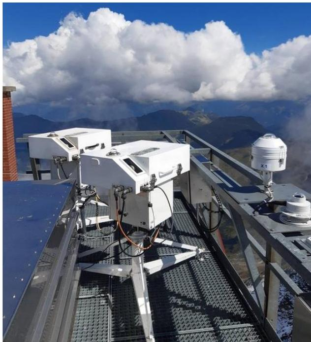
Abbildung 22: Brewer Spektrophotometer 093 und 017 am Standort Sonnblick, Kalibrierung 2021 (Sonnblick Observatorium 2022).
