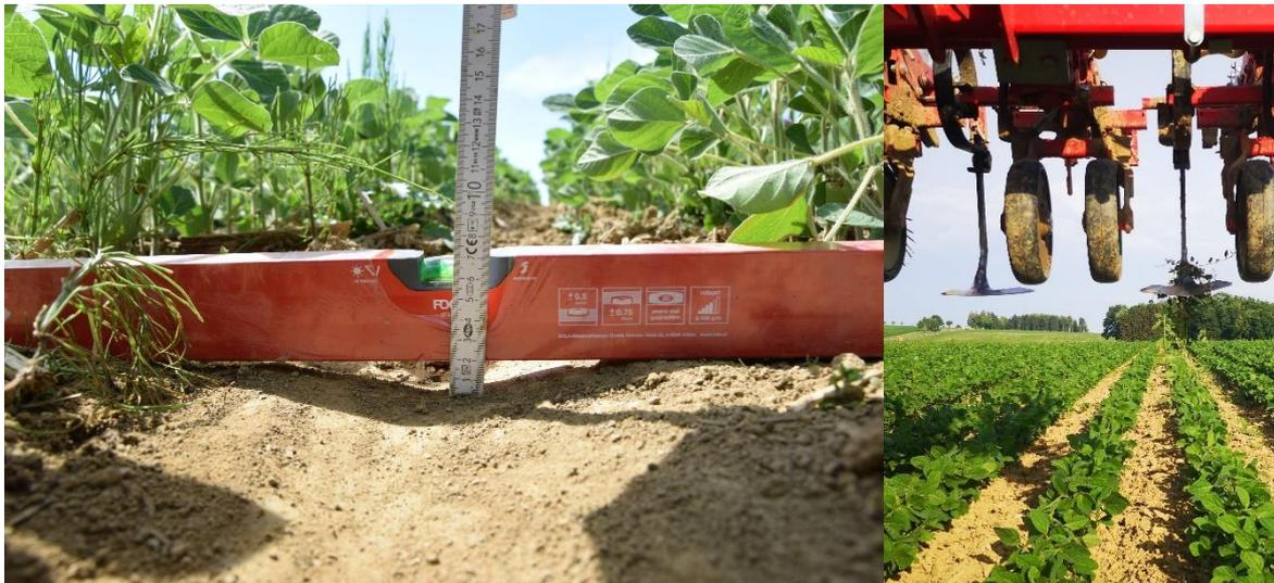
Abbildung 21 links: Arbeitsprofiltiefe der Gänsefußschar, rechts: das Hackgerät als Gänsefußschar-Ausführung
