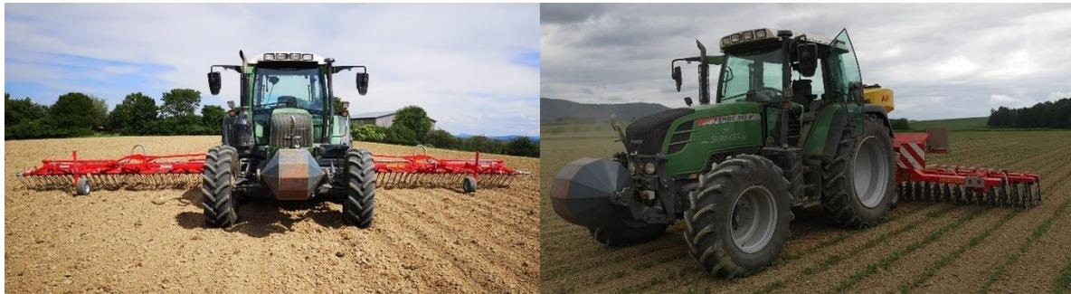
Abbildung 19 Links Fendt 313 mit Einböck Zinkenstiel, rechts mit Einböck Rotorhacke
