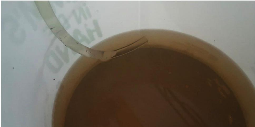
Abbildung 29 Überschüssiges Wasser wird abgehebert
