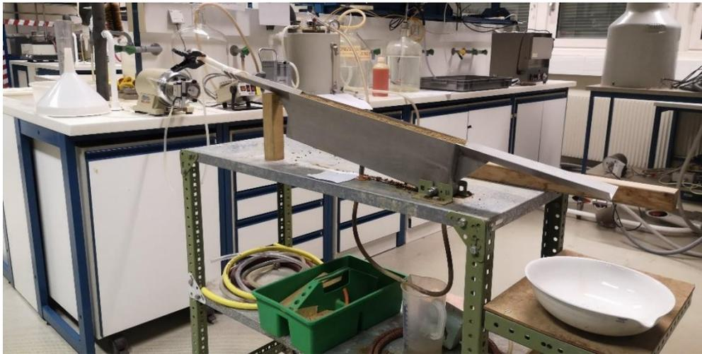
Abbildung 34 Aufbau der Apparatur zur Messung der Rillenerosion
