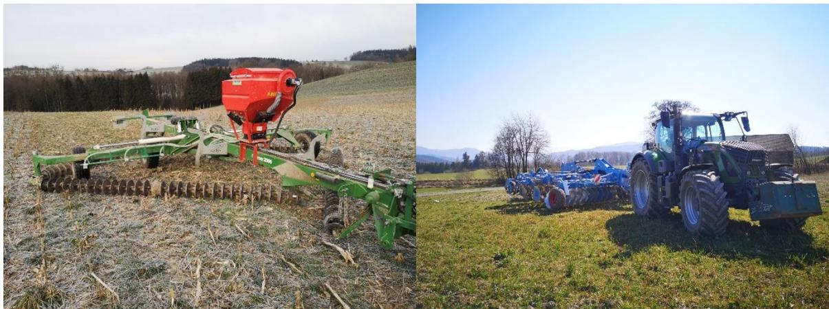
Abbildung 16 Links Kettenscheibenegge Kelly 2006, rechts Lemken Rubin 10 bei der Bodenbearbeitung
