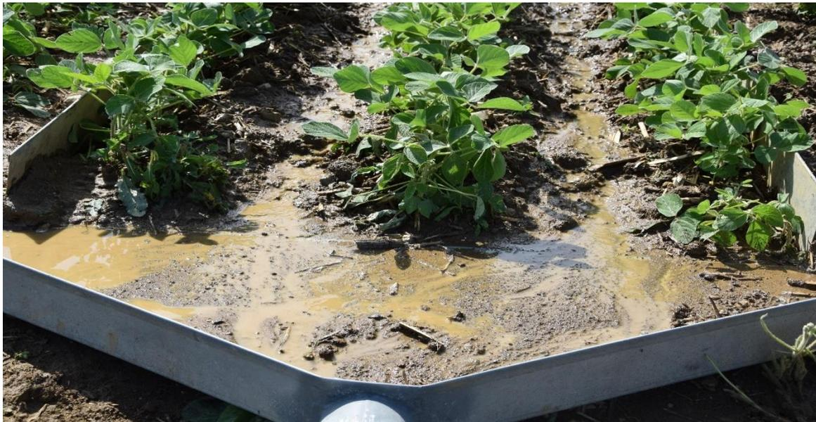
Abbildung 10 Wassererosion hervorgerufen durch Überflutung der Versuchsparzelle
