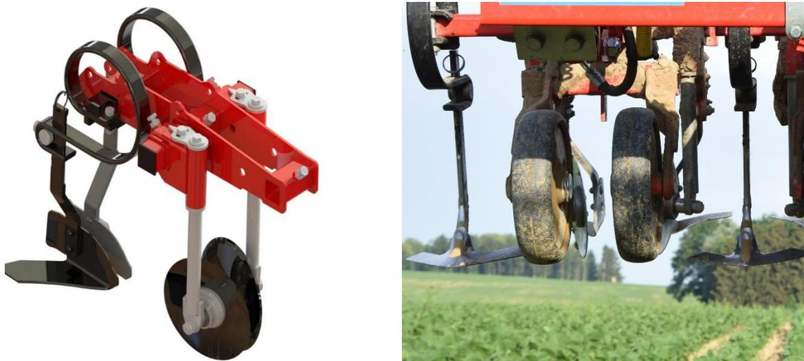
Abbildung 6 Hackelement Hohlscheiben-Winkelschartechnik (Twin System) (www.einböck.at, 2023)
