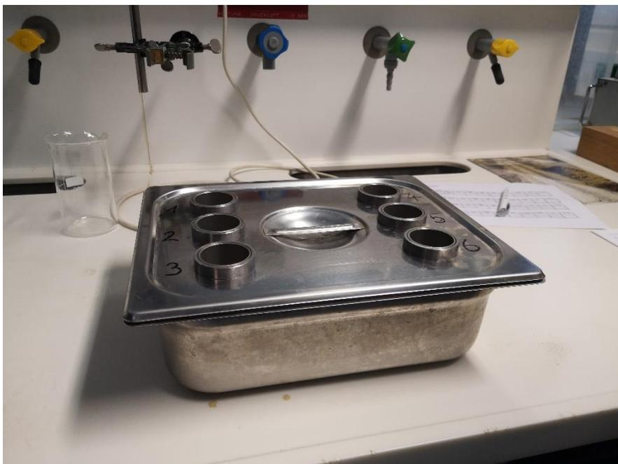
Abbildung 33 Siebvorrichtung für die Bestimmung der Aggregatstabilität
