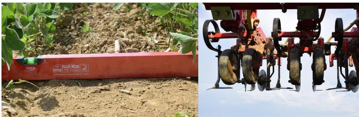
Abbildung 20 Links Arbeitsprofil der Schneidscheiben-Winkelschartechnik, rechts Arbeitswerkzeuge
