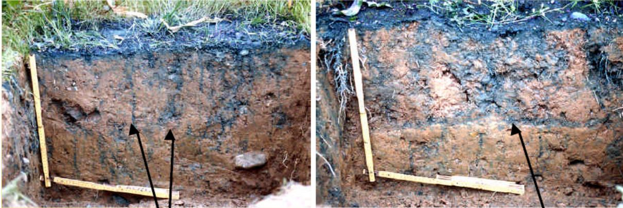
**Abbildung 2.8:** links: Die Infiltration von gefärbtem Wasser in einen minimal bearbeiteten Boden
