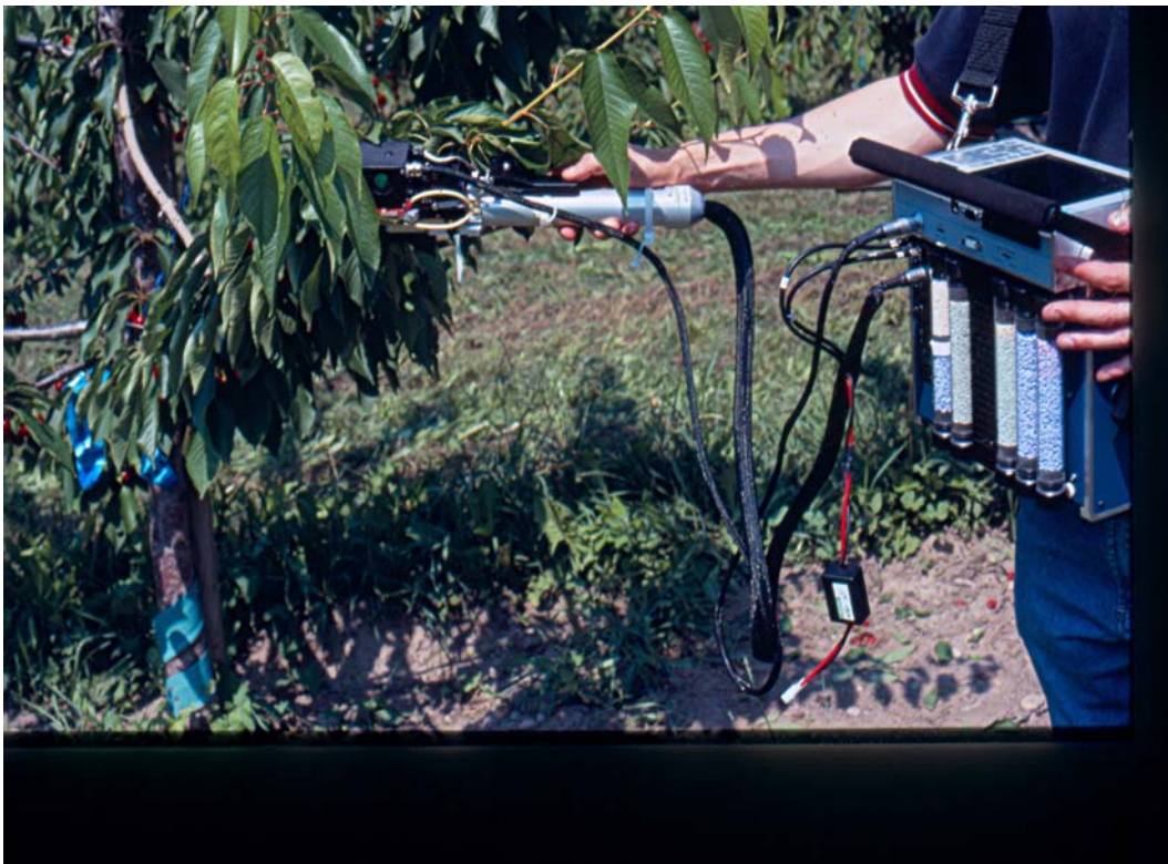
Abbildung 9: CIRAS-2-Messgerät mit eingebautem Chlorophyllfluoreszenzmodul
