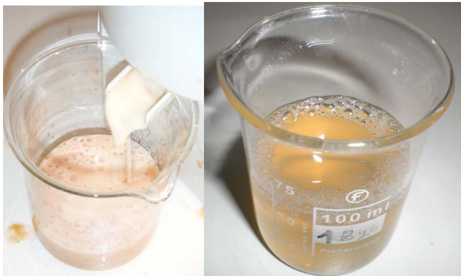
Abbildung 16: Saft vor und nach der Filtration
