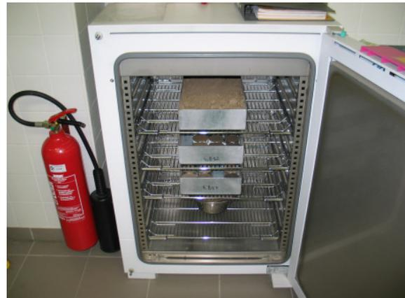
**Abbildung 32:** Trocknung der Stechzylinderproben im Trockenschrank; Labor am Institut für Geotechnik/BOKU; 07.12.2006
