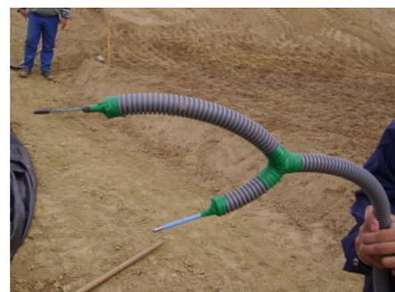
**Abbildung 58:** Feuchtigkeits- und Temperatursensoren, Versuchsanlage Deutsch Wagram/Niederösterreich; 18.04.2007
