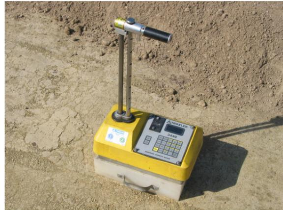
**Abbildung 39:** Isotopensondenmessungen in der Lehmschicht des Versuchsdammes; 05.04.2007
