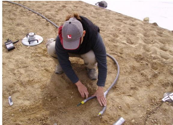
**Abbildung 59:** Einbau der Messsensoren in 3. Schichten, Versuchsanlage Deutsch Wagram/Niederösterreich:
