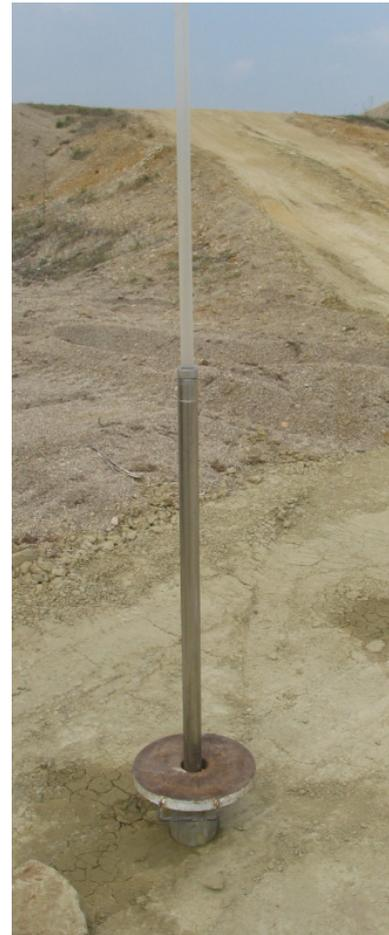
**Abbildung 37:** Infiltrometer nach Horn (11.04.2007)
