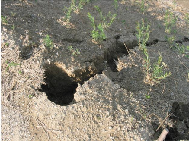
**Abbildung 110:** Rillenbildung an den Böschungen, Versuchsanlage Deutsch Wagram/Niederösterreich; 12.06.2007
