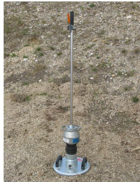
**Abbildung 33:** Dynamische Lastplatte (INTERNET 4) und dynamische Lastplatte des Institutes
