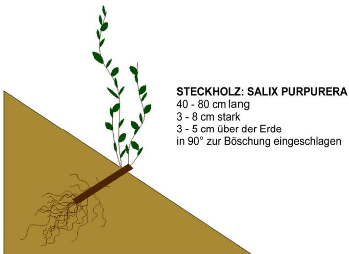
**Abbildung 73:** Steckholzpflanzungen, Versuchsanlage Deutsch Wagram/Niederösterreich
