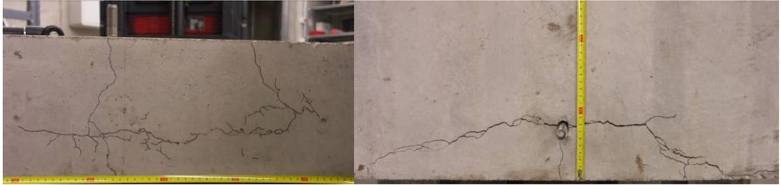
Abb. 9.2: E\_1\_L\_C30-37\_02\_A Bruchbild li: Stirnseite re: Oberseite
