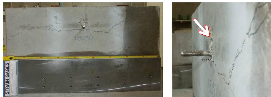
*Abb. 11.5: 135 135\_90 li: Bruchbild; re: große Ankerverformung und Abplatzung*
