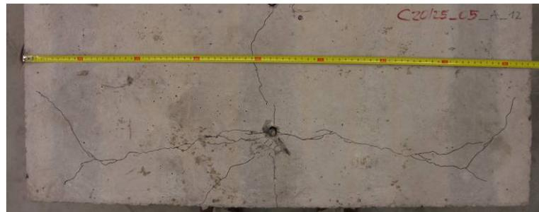
Abb. 9.13: E\_2\_P\_C20-25\_05\_A\_12: Bruchbild
