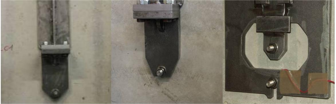
*Abb. 8.7 li.: Adapter für EV M 12 und M 16, passgenau; mi.: Adapter für EV M 12 und M 16, Langloch; re.: Adapter für DV M12 und M 16*
