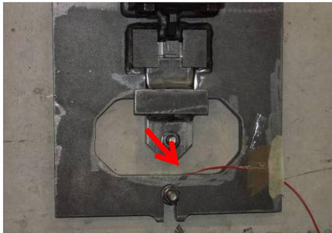
Abb. 8.8: Position des Dehnungsmessstreifens hinter dem randnahen Anker
