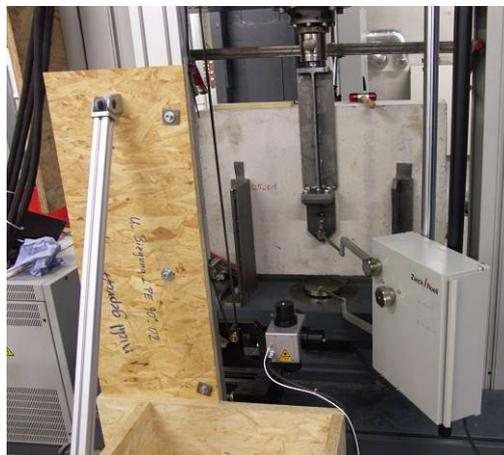
*Abb. 8.10: Lagerung ohne direkte Verbindung zwischen Betonoberfläche und Interferometer*
