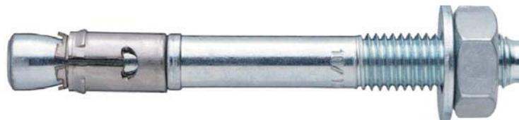
*Abb. 1.5 Drehmomentkontrolliert spreizender risstauglicher Dübel des Bolzentyps M12 FAZ12/30 A4 [5]*
