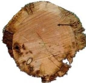
Abb 87: Bohrstreifen und Vergleichsrundholzscheibe (Lärchenholz 14 Jahre)
