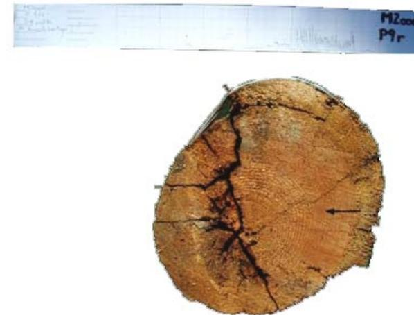
Abb 95: Bohrstreifen und Vergleichsrundholzscheibe (Lärchenholz 16 Jahre) M2000 P9 r, Meran 2000 09/2006
