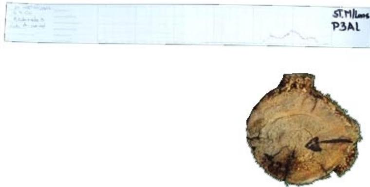
Abb 91: Bohrstreifen und Vergleichsrundholzscheibe (Lärchenholz 22 Jahre) St.MLaas
