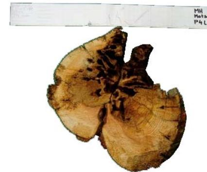
Abb 86: Bohrstreifen und Vergleichsrundholzscheibe (Lärchenholz 14 Jahre) SbMh P4 I, Saldurbach Mühlhöfe Matsch 09/2006
