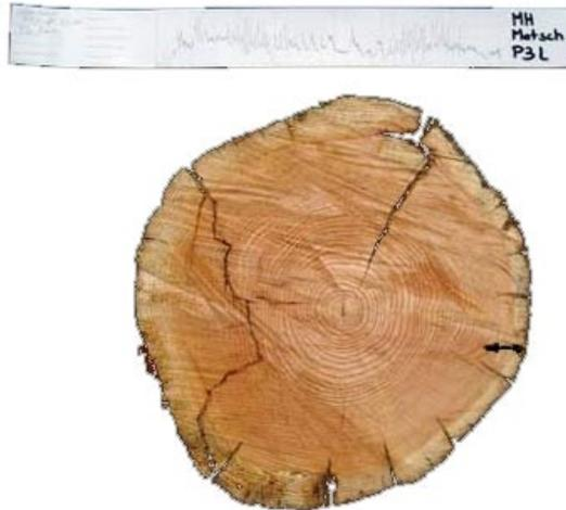
Abb 85: Bohrstreifen und Vergleichsrundholzscheibe (Lärchenholz 14 Jahre) SbMh P3 I, Saldurbach Mühlhöfe Matsch 09/2006
