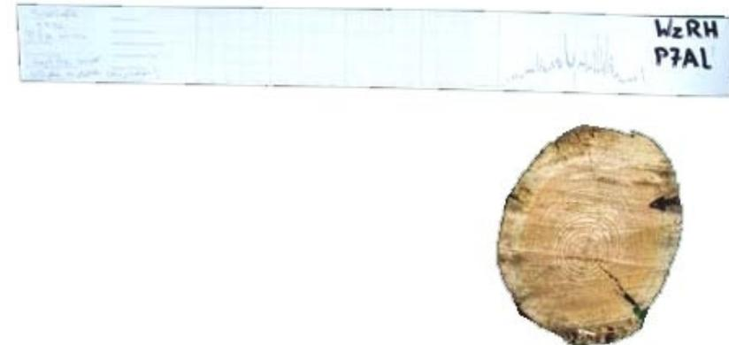
Abb 84: Bohrstreifen und Vergleichsrundholzscheibe (Lärchenholz 10 Jahre) WzRH P7 A I,
