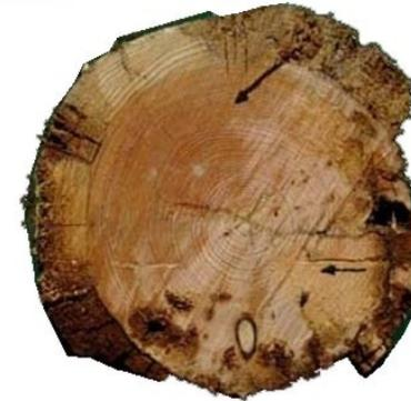
Abb 88: Bohrstreifen und Vergleichsrundholzscheibe (Lärchenholz 14 Jahre)
