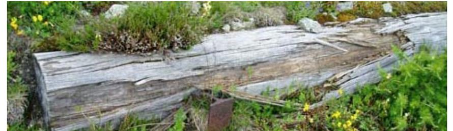
Abb 110: abgeschältes Splintholz (Lärche, 15 Jahre) am Standort 6 Meran 2000, 09/2006
