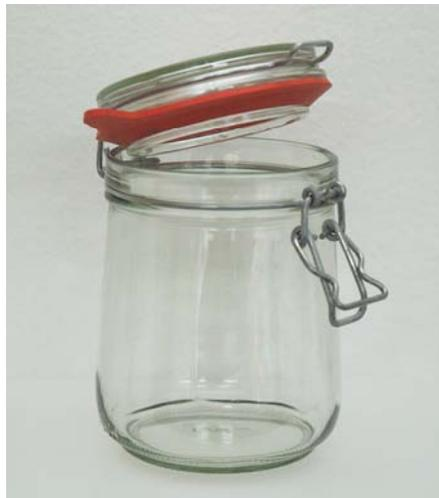
**Abbildung 9:** Ein Liter Einweckglas als Versuchsgefäß für die Probeentnahme während der Gärphase im Silierversuch S-54 am LFZ Raumberg-Gumpenstein im Jahre 2005
