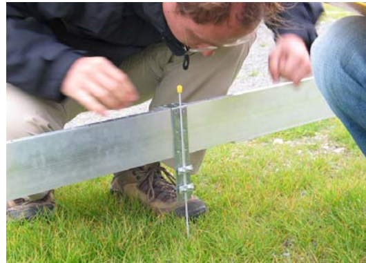
Abb. 23 Schlitten auf der Alulatte mit Stricknadel, durch die alle 3 cm ein Punkt aufgenommen werden kann (September 2007).
