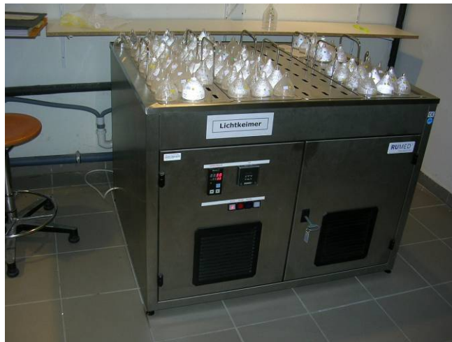
Abb. 10 RUMED® Jacobsen-Keimapparat Serie 5001 mit Keimglocken für Lichtkeimer im Labor des Institutes für Ingenieurbiologie und Landschaftsbau Jänner 2007
