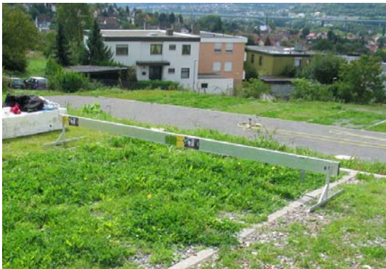
Abb. 22 Aufnahmegärts bestehend aus einer 4m Alulatte, in die 80 Löcher gebohrt wurden. Versuchsfläche Veitshöchheim zur Durchführung der Line-point-Methode (September 2007)
