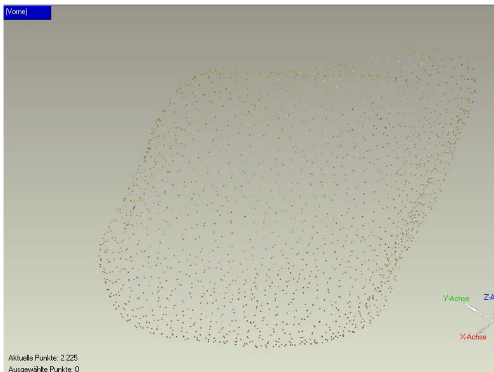
Abb. 43: Ansicht des Kalksteines – Reduktion auf 2.200 Punkte, Geomagic (2007)
