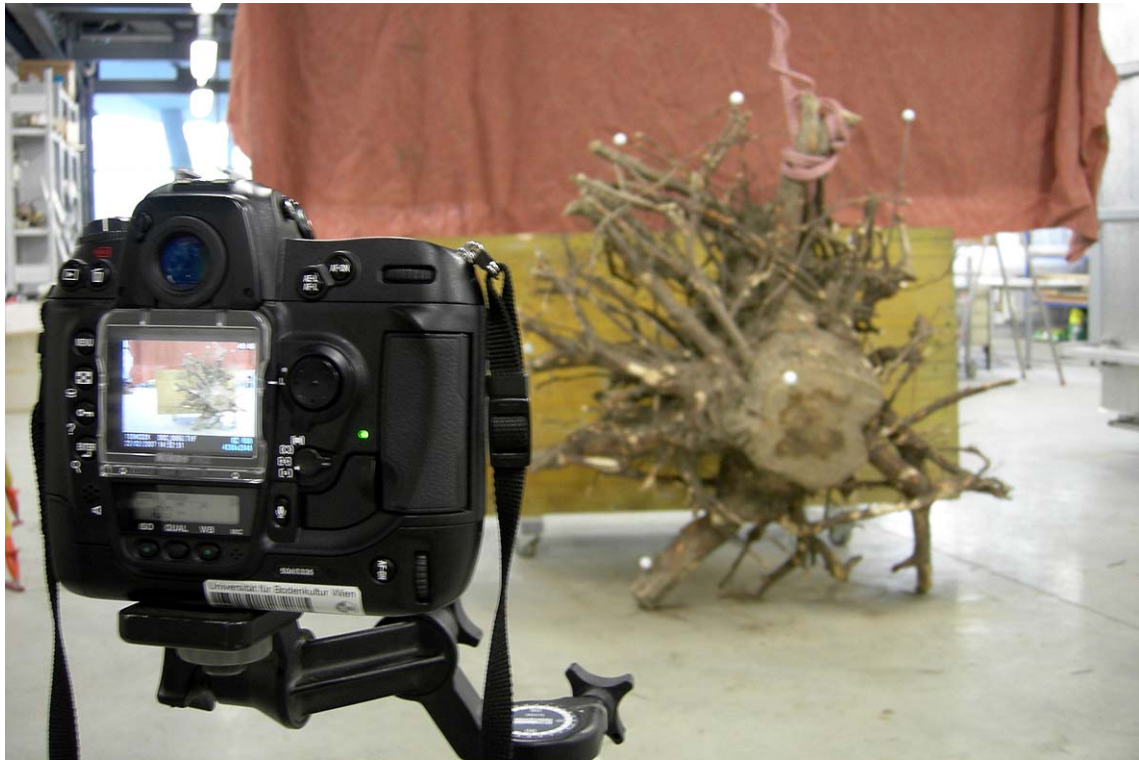
Abb. 28: photogrammetrische Aufnahme mit Nikon D2X, 28mm Objektiv, Technikum BOKU (02.2007)
