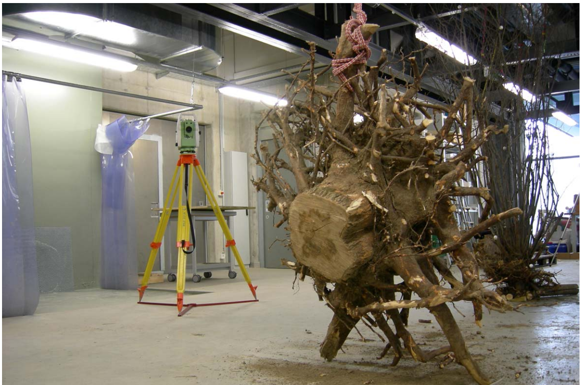
Abb. 27: photogrammetrische Aufnahme – Ahorn-Wurzelstock, Technikum BOKU (02.2007)
