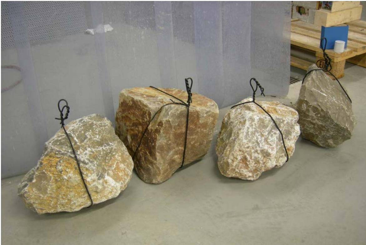
Abb. 11: Kalksteine mit Drahtbefestigung zum Abhängen von der Deckenkonstruktion (12.2006)
