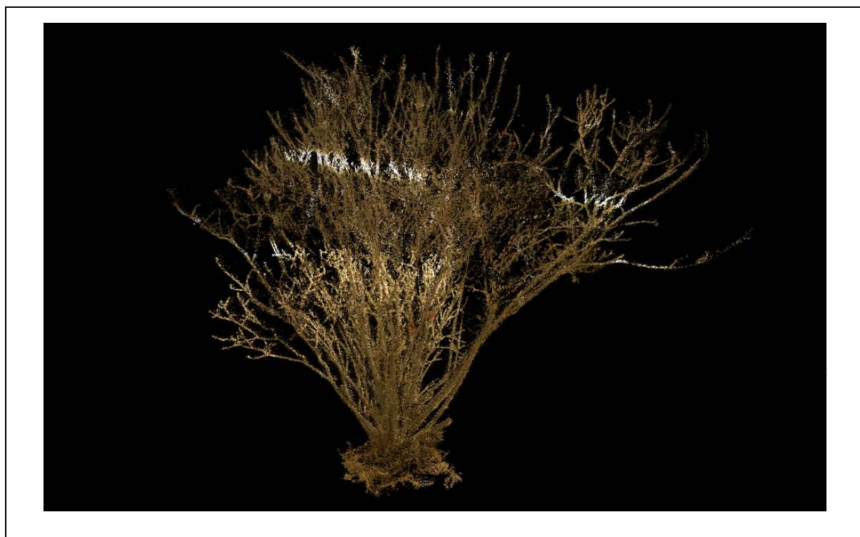
Abb. 30: Ergebnis des Laserscans – isolierte Punktwolke der Purpurweide, RiSCAN PRO (2007)
