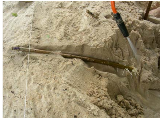
Abb. 75 u. 76: Auswaschen der Steckhölzer (Versuch Einlagewinkel in Sand mit Phyllanthus sellowianus , Santa Maria / UFSM Dez. 2008)
