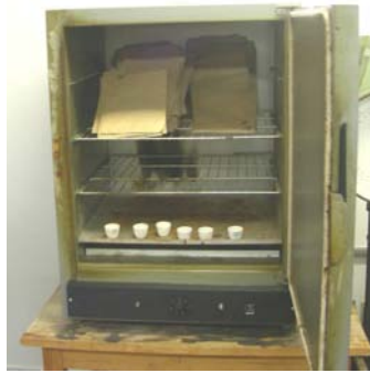
Abb. 37: Trocknen der Sprosse und Wurzeln im Trockenofen (Versuch Einlageverhältnis in Sand mit Salix humboldtiana , Santa Maria / UFSM, Dez. 2008)
