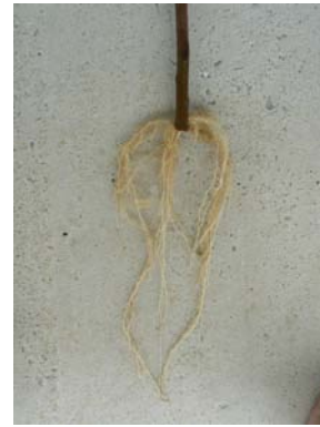
Abb. 86: Wurzelentwicklung bei Einlagewinkel 10° (Versuch Einlagewinkel in Sand mit Phyllanthus sellowianus , Santa Maria, Dez. 2008)
