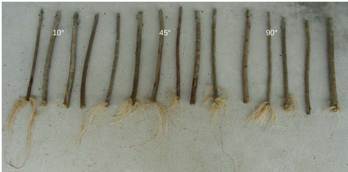
Abb. 77: Steckhölzer der ersten 3 Reihen; 5 pro Reihe und Einlagewinkel (Versuch Einlagewinkel in Sand mit Phyllanthus sellowianus , Santa Maria, Dez. 2008)
