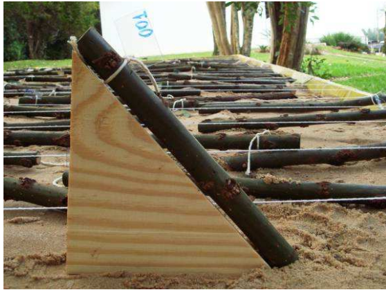
Abb. 31: Einlegen der Steckhölzer in 45° (Versuch Einlageverhältnis in Sand mit Salix humboldtiana , Santa Maria / UFSM, Mai 2008)
