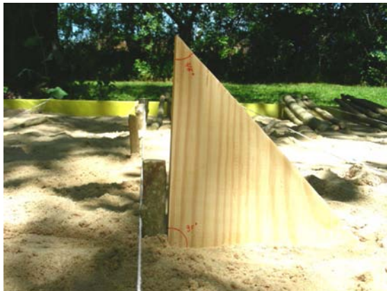
Abb. 68: Holzdreieck für die Einlagewinkel 45 und 90° (Versuch Einlagewinkel in Sand mit Phyllanthus sellowianus , Santa Maria / UFSM, Okt. 2008)
