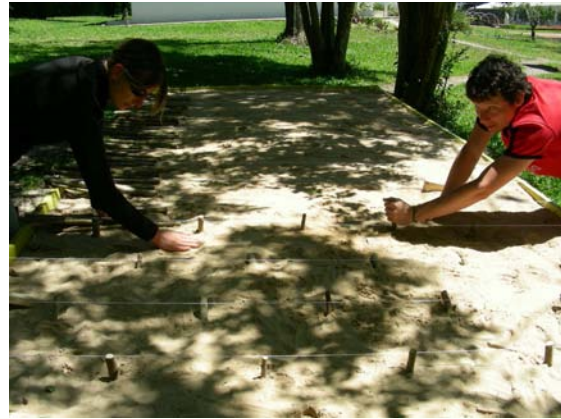
Abb. 65: Einschlagen der Steckhölzer (Versuch Einlagewinkel in Sand mit Phyllanthus sellowianus , Santa Maria / UFSM, Okt. 2008)
