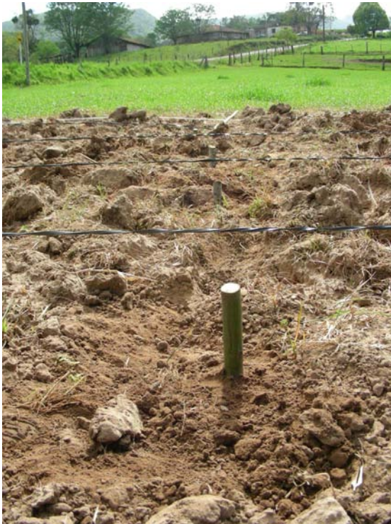
Abb. 152: Eingeschlagenes Steckholz (Versuch Auszugwiderstand, Vale Veneto, Sept. 2008)
