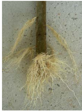
Abb. 85: Wurzelentwicklung bei Einlagewinkel 45° (Versuch Einlagewinkel in Sand mit Phyllanthus sellowianus , Santa Maria, Dez. 2008)
