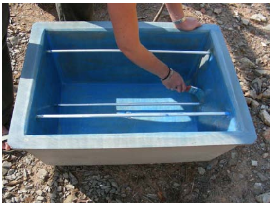
Abb. 101: Ausmalen des Betonbeckens (Versuch Einlagewinkel in Wasser mit Phyllanthus sellowianus , Santa Maria / UFSM, Okt. 2008)
