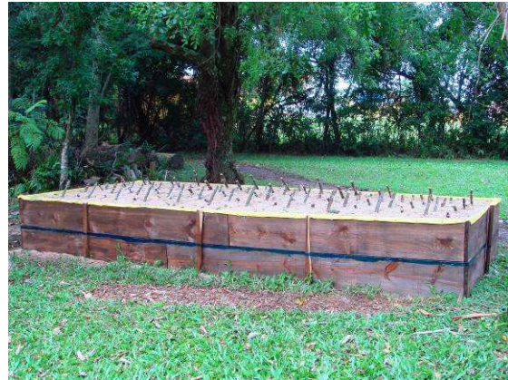
Abb. 32: Versuch nach Fertigstellung (Versuch Einlageverhältnis in Sand mit Salix humboldtiana , Santa Maria / UFSM, Mai 2008)
