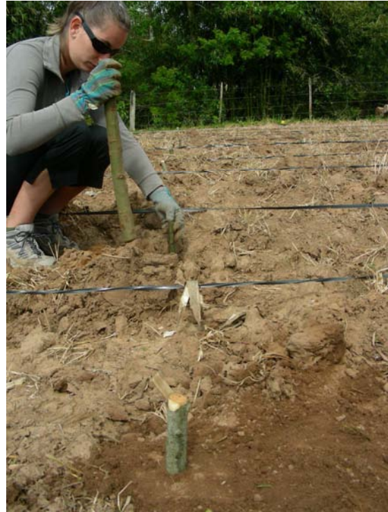
Abb. 150: Einlegen der Steckhölzer (Versuch Auszugwiderstand, Vale Veneto, Sept. 2008)
