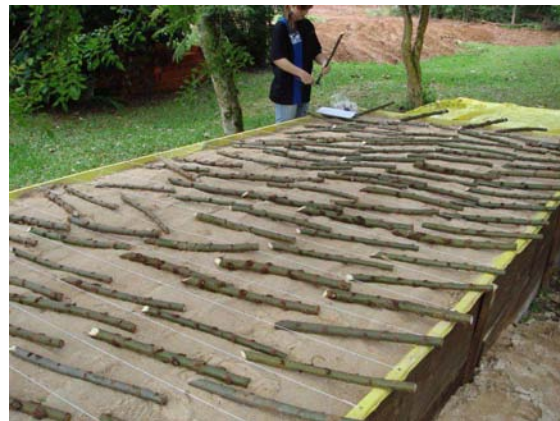
Abb. 28: Positionierung der Steckhölzer (Versuch Einlageverhältnis in Sand mit Salix humboldtiana , Santa Maria / UFSM, Mai 2008)
