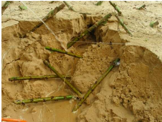
Abb. 39: Auswaschen der Steckhölzer (Versuch Einlageverhältnis in Sand mit Salix humboldtiana , Santa Maria / UFSM, Sept. 2008)
