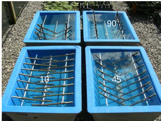
Abb. 103: Anordnung der Betonbecken (Versuch Einlagewinkel in Wasser mit Phyllanthus sellowianus , Santa Maria / UFSM, Okt. 2008)
