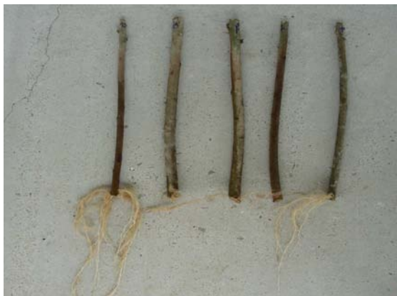
Abb. 98: Wurzelbildung im Einlagewinkel 10° (Versuch Einlagewinkel in Sand mit Phyllanthus sellowianus , Santa Maria / UFSM, Nov. 2008)
