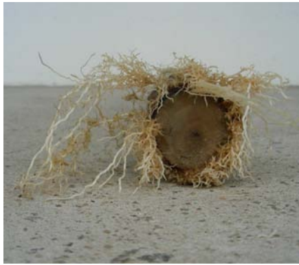
Abb. 84: Wurzelentwicklung bei Einlagewinkel 90° (Versuch Einlagewinkel in Sand mit Phyllanthus sellowianus , Santa Maria, Dez. 2008)
