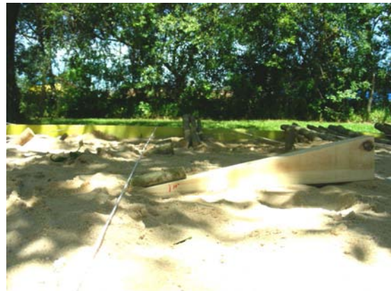
Abb. 69: Holzdreieck für den Einlagewinkel 10° (Versuch Einlagewinkel in Sand mit Phyllanthus sellowianus , Santa Maria / UFSM, Okt. 2008)
