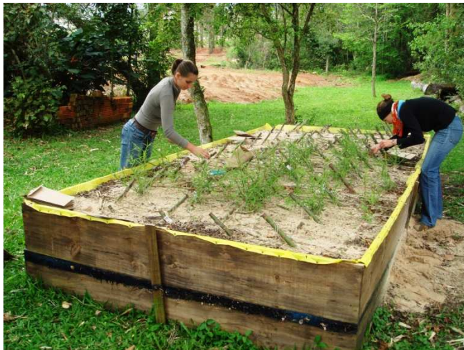
Abb. 34: Schneiden der Sprosse (Versuch Einlageverhältnis in Sand mit Salix humboldtiana , Santa Maria / UFSM, Sept. 2008)
