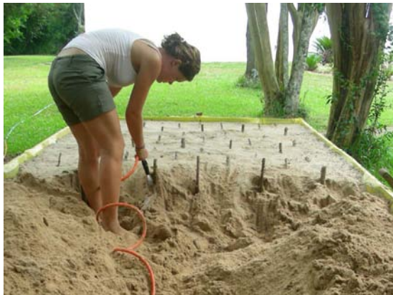
Abb. 75 u. 76: Auswaschen der Steckhölzer (Versuch Einlagewinkel in Sand mit Phyllanthus sellowianus , Santa Maria / UFSM Dez. 2008)
