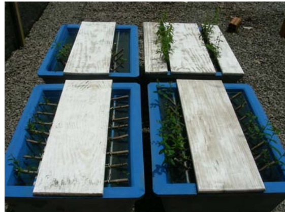
Abb. 104: Betonbecken mit Holzabdeckung (Versuch Einlagewinkel in Wasser mit Phyllanthus sellowianus , Santa Maria / UFSM, Okt. 2008)
