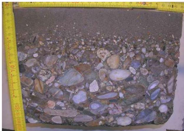
*Abb. 3.2 Entmischung von Beton [2]*
