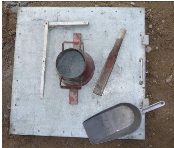
Abb. 3.3 Geräte zur Bestimmung des Ausbreitmaßes
