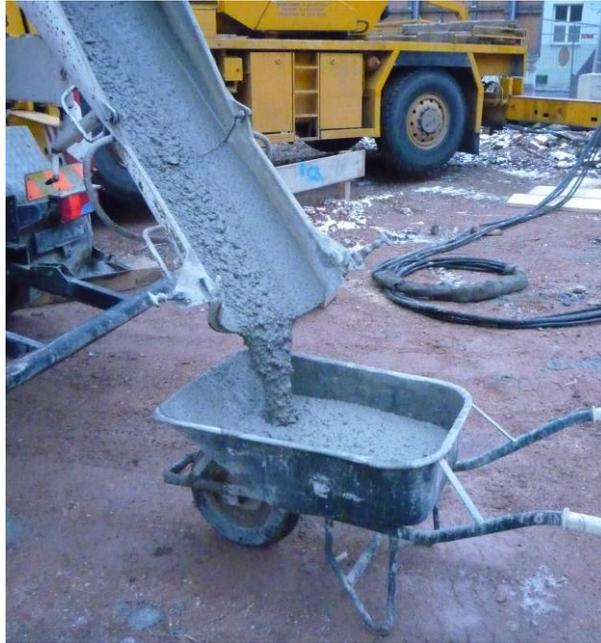
*Abb. 3.1 Probenahme aus Fahrmischer*
