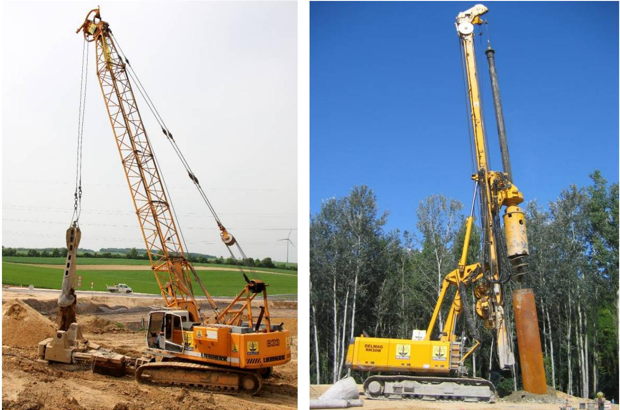
*Abb. 4.4 Greiferbohrung / Drehbohrung [Grund-, Pfahl- und Sonderbau Archiv]*
