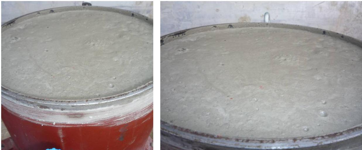
*Abb. 5.8 Betonfilterpresse BPV nach Versuchende*
