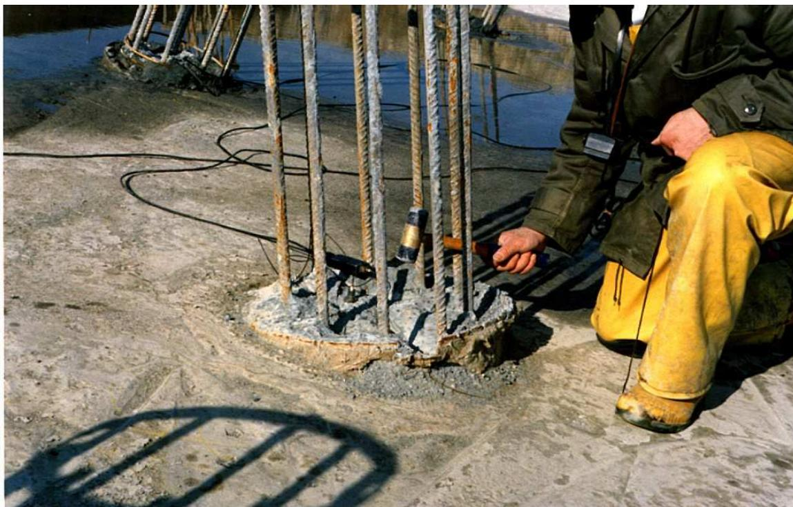
Abbildung 6-17: Integritätsprüfung-Meßsystem [BENEKE, A.; Integritätsprüfung FPDS (Homepage)]
