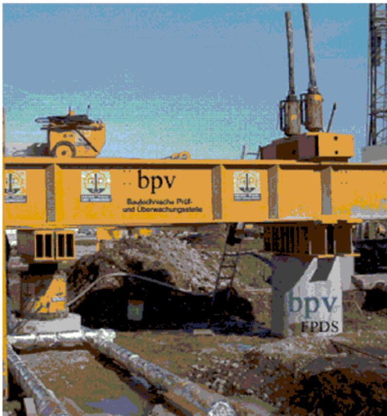
Abbildung 6-5: Belastungsprobe SC-Villach [Homepage GPS/bpv]
