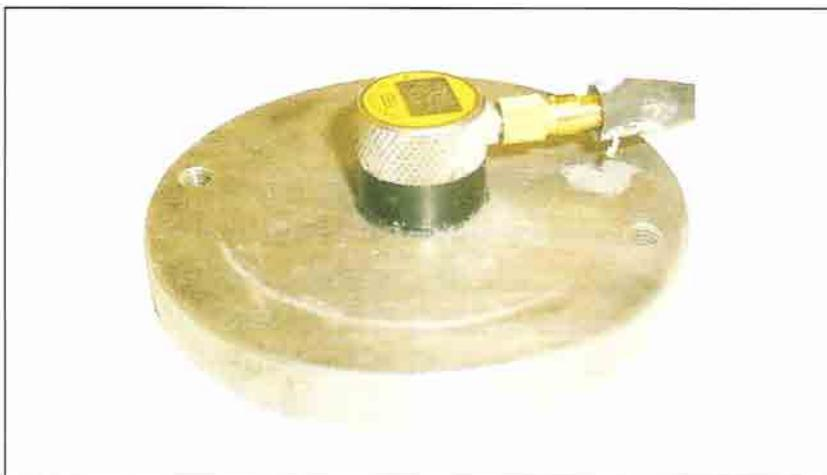
*Abbildung 6-39: In Laborversuchen verwendete Kombination von Ultraschallsensor und Stahlplatte [VOIGT; DEHN; und SHAH; (2004)]*
