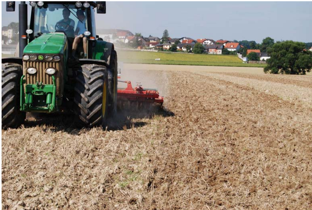
Abbildung 21: Partielle Streifenbildung bei der Bearbeitung mit der GPS - Lenkhilfe
