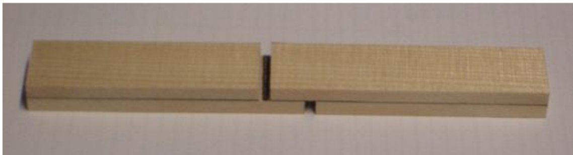
Abbildung 10: Darstellung der Zugscherprobengeometrie nach ÖNORM EN 302-1 (2004)
