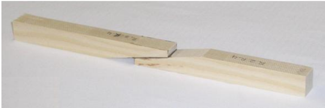
Abbildung 11: Darstellung der Schäftprobengeometrie in Anlehnung an die ehemalige DIN 53 253 (1964)
