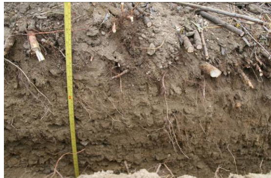
Abbildung 163: Messung der Wurzeltiefe (50 cm) an der Weidenspreitlage des Ausgrabungsdammes, Sektor 13 (Deutsch-Wagram, Oktober 2008).
