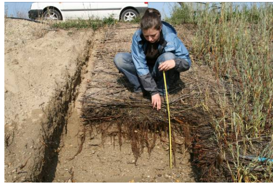
Abbildung 165: Messung der Wurzeltiefe (50 cm) an der Weidenspreitlage des Ausgrabungsdammes, Sektor 13 (Deutsch-Wagram, Oktober 2008).
