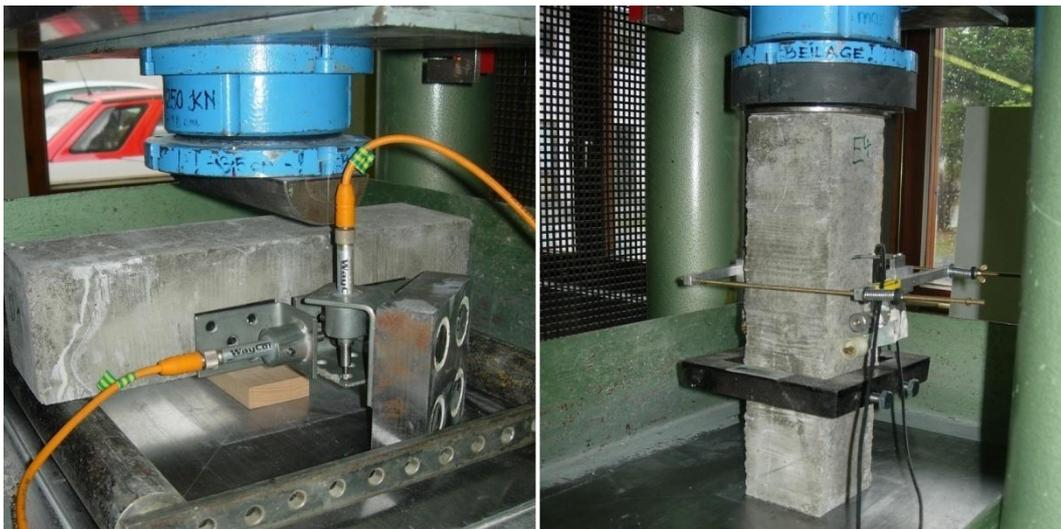
Abbildung 30: Dreipunkt-Biegezugversuch zur Ermittlung der Bruchenergie und Versuch zur Ermittlung des E-Moduls von Beton. Aus [61].
