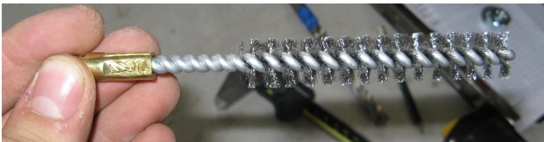
Abbildung 38: Stahldrahtbürste zur Bohrlochreinigung
