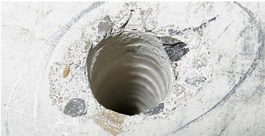
Abbildung 58: Bohrloch nach dem Bohrvorgang. Sichtbar sind anhaftendes Bohrmehl und Abdrücke der Bohrwendel.
