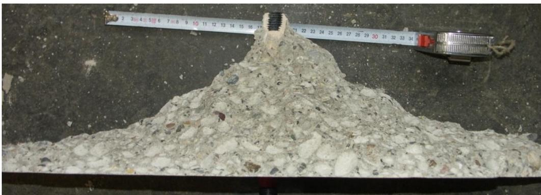
Abbildung 7: Betonausbruchkegel
