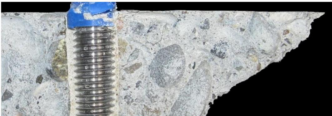
Abbildung 4: Verbundanker im Beton
