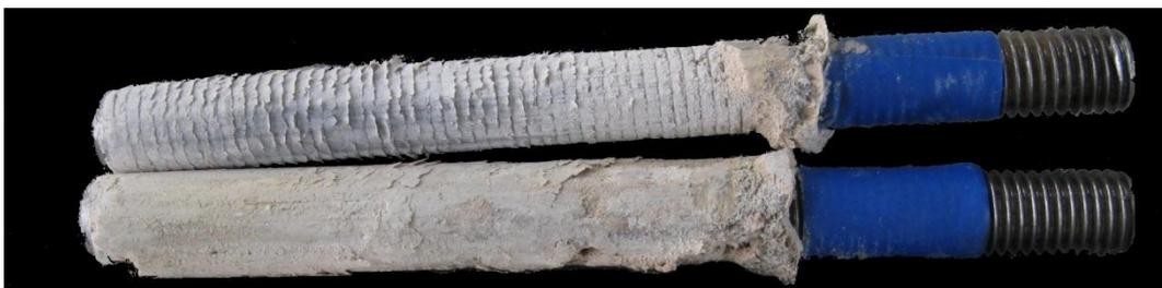
**Abbildung 8: Grenzflächenversagen bei Verbunddübeln. Oben Interface Mörtel-Gewindestange, unten Interface Mörtel-Beton**
