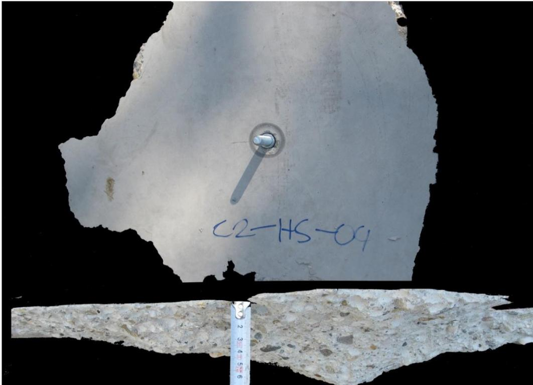
Abbildung 40: Ausbruchkegel eines Hinterschnittankers
