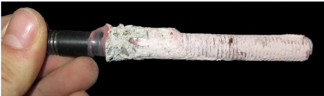
Abbildung 46: Mischbruch des Systems „Typ B“ bei der Hälfte der vorgegebenen Reinigung
