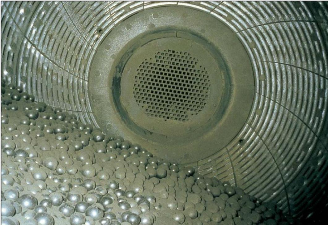
Abbildung 18: Kugelmühle (aus [38])
