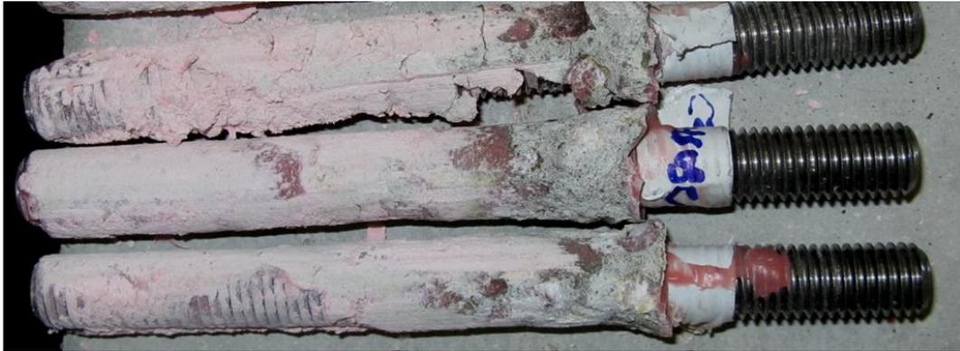
Abbildung 43: Mischbruch als Versagensursache beim verwendeten System „Typ B“
