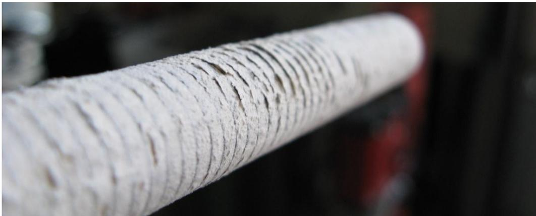
Abbildung 42: Grenzflächenversagen zwischen Gewindestange und Verbundmörtel.
