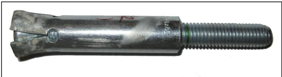
Abbildung 6: Hinterschnittanker fischer FZA 18x80 (nach einem Auszugsversuch fotografiert)
