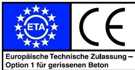
Abbildung 10: Beispiel für einen Verpackungsaufdruck eines nach ETAG 001 zugelassenen Dübels
