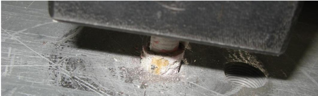
Abbildung 55: Auszug eines gesamten Verbundmörtelkörpers durch das Durchgangsloch
