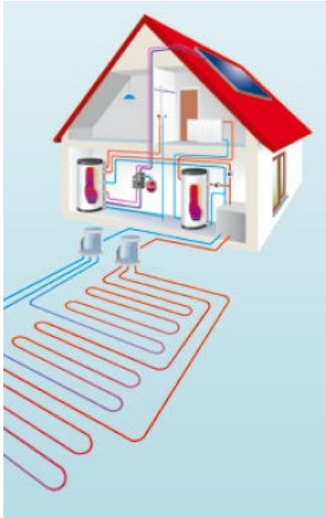
**Abbildung 4.13** horizontaler Erdwärmetauscher (schematische Darstellung) (aus [BDH, 2008c])
