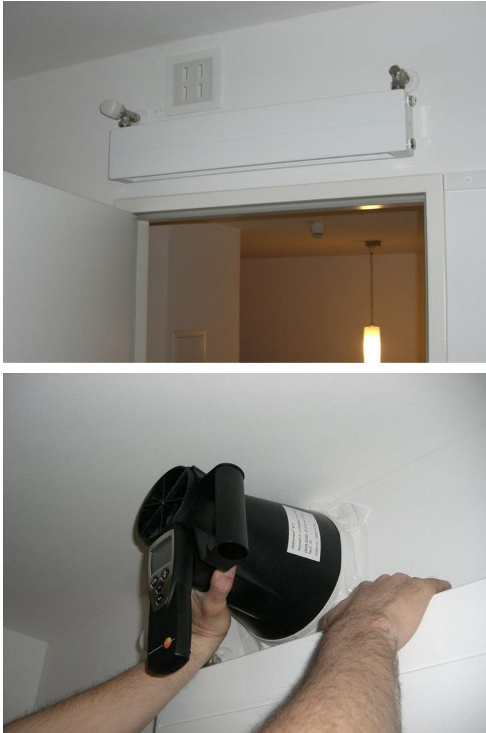
**Abbildung 6.1** Zuluftauslass und Volumenstrom- / Temperaturmessung im Passivhaus Studentenheim Molkereistraße in Wien. Fotos: W. Oberkleiner
