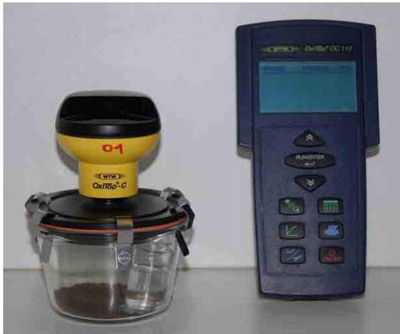
**Abbildung 5:** Das zur Differenzierung von Standorten mittels optimiertem CRP verwendete OxiTop<sup>®</sup>-C System. links: Messeinheit, bestehend aus Messkopf mit Gummiring, Einmachglas und Gefäß mit CO<sub>2</sub>-Absorber, rechts: Fernbedienung
