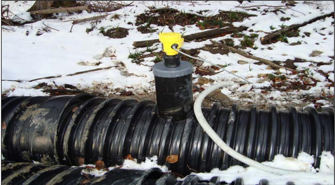
Abb. 50 Ultraschallsensor Vegason 61 eingebaut am Gschlifegraben
