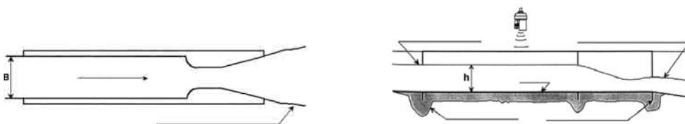
Abb. 5. Grundriss und Längenschnitt eines Venturigerinnes (aus [4], 127)
