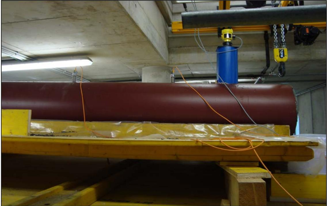
Abb. 16 Ultraschallsensoren eingebaut in einem Rohr mit 500mm Durchmesser
