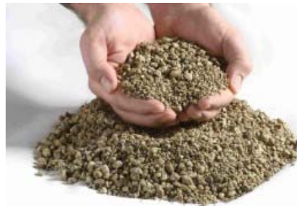
Abb.33: Drainschicht: Schüttstoff / Kies (Quelle: www.zinco.at)
