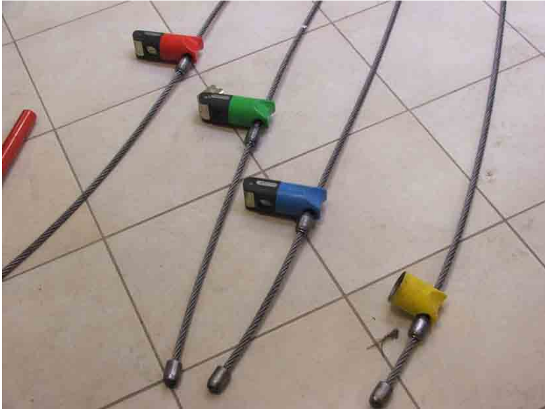
Abbildung 23: Versetzte Anordnung der Ludwig Choker (Quelle: Leitner 2008)
