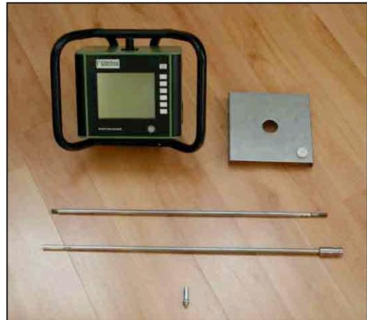
**Abb. 40** Penetrologger, Sondierstangen, Konus und Tiefenbezugsplatte des Instituts für Ingenieurbiologie und Landschaftsbau, BOKU Wien
