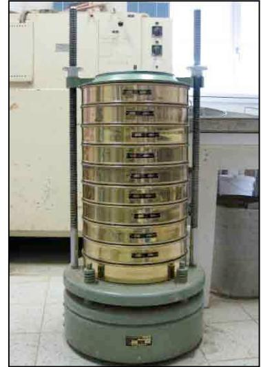
**Abb. 36** Siebturm für die Grob- und Mittelsiebung im Bodenlabor des Instituts für Geotechnik, BOKU Wien
