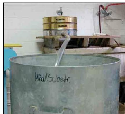
**Abb. 33** Siebturm und Bottich für Schlämmanalyse im Bodenlabor des Instituts für Geotechnik, BOKU Wien
