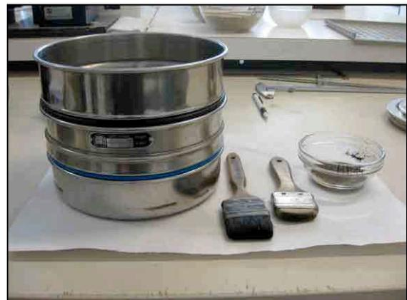
**Abb. 37** Siebturm für Feinsiebung im Bodenlabor des Instituts für Geotechnik, BOKU Wien
