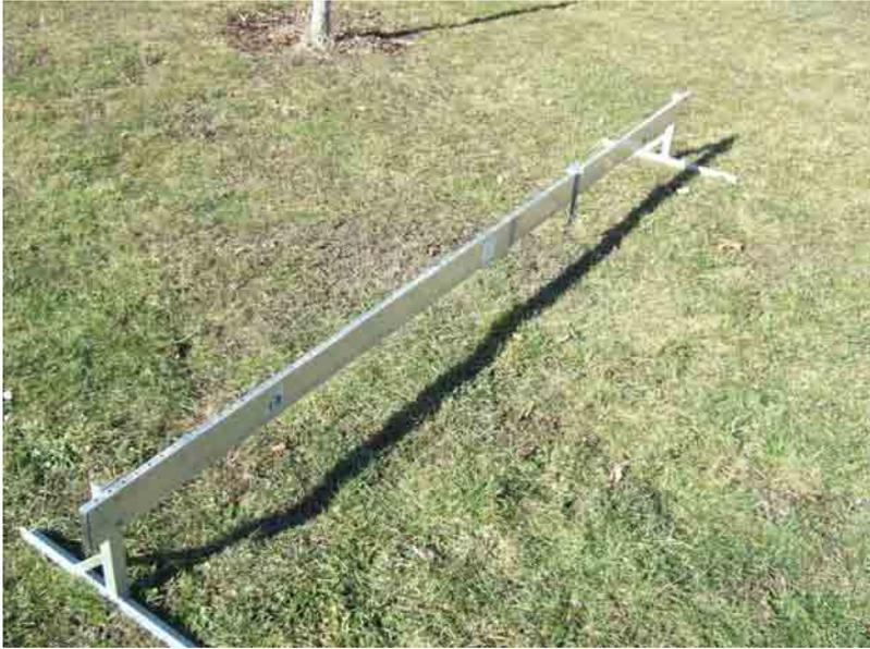
**Abbildung 11:** Aufnahmegerät der Line-Point-Methode, Alulatte mit 80 Bohrlöchern im Abstand von 3cm, entwickelt beim GREEN CONCRETE Projekt, Versuchsgarten Wien, Essling, 2009.
