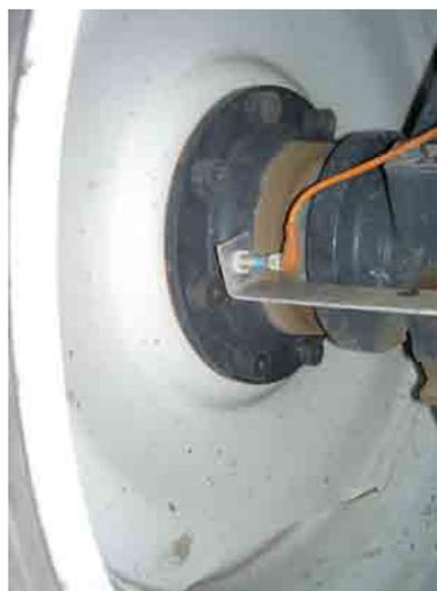
**Abbildung 17: Radnabensensor**
