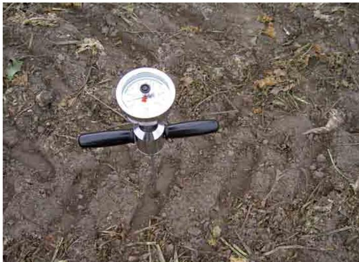
Abbildung 31: Analoges Penetrometer
