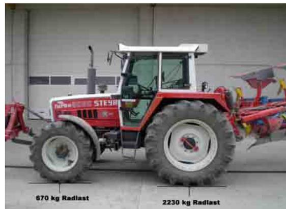
**Abbildung 14: Radlasten des Versuchstraktors mit abgesenktem und angehobenem Pflug**
