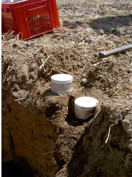
**Abbildung 29: Stechzylinder für die Probenentnahme**
