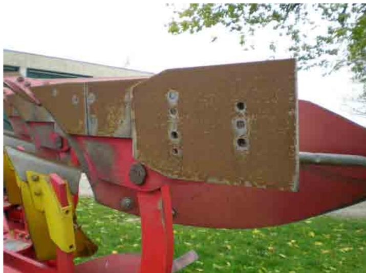
**Abbildung 19: Verstärkte Anlagen für den Onland - Betrieb**
