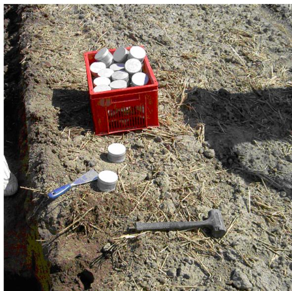
**Abbildung 30: Werkzeug für die Probenentnahme**
