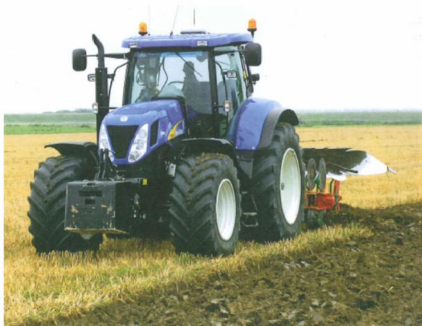
**Abbildung 11: Onland - Pflügen mit GPS Steuerung**
