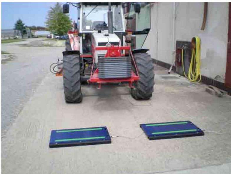
**Abbildung 13: Ermittlung der Rad- und Achslasten**
