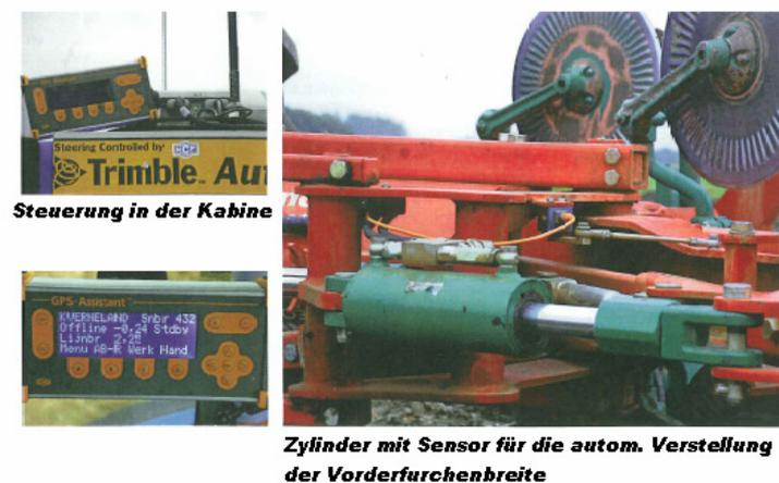
**Abbildung 12: Steuerung der Vorderfurchenbreite über Sensor und Hydraulikzylinder**
