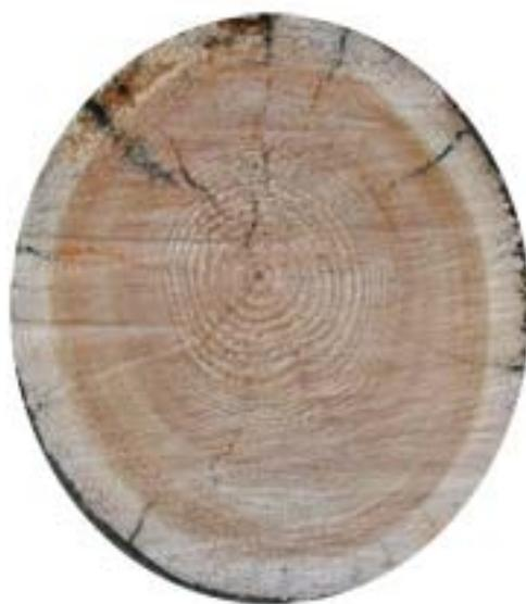
**Abb. 34: Stammscheibe eines Lärchenrundholzes: Gut erkennbar sind die Jahrringe (breit im Kernbereich, werden zum Splint hin immer schmaler), der breite Kern und der schmale (helles Holz) Splint**
