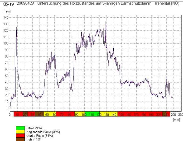
Abb. 143: Bohrung am eingelegten Kiefernholz (Längsholz) des 5-jährigen Lärmschutzwalles im Irenental/NÖ, April 2009
