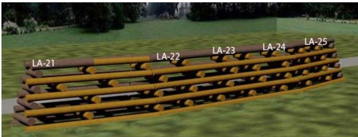
Abb. 106: Verteilung der Bohrungen LA-21 bis 25 (Hinterseite), alle Bohrungen vertikal durchgeführt, am 5-jährigen Lärmschuttwall im Irenental/NÖ
