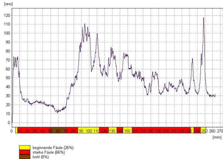
**Abb. 151: Bohrung am eingeleigten Kiefernholz (Querholz) des 5-jährigen Lärmschutzwalles im Irenental/NÖ, November 2008**
