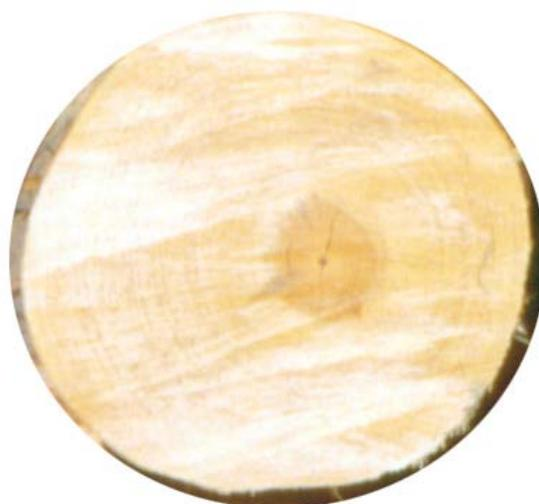
**Abb. 38: Stammscheibe eines Kiefernrundholzes: Gut erkennbar ist der schmale Kern und der breite Splint (helles Holz)**
