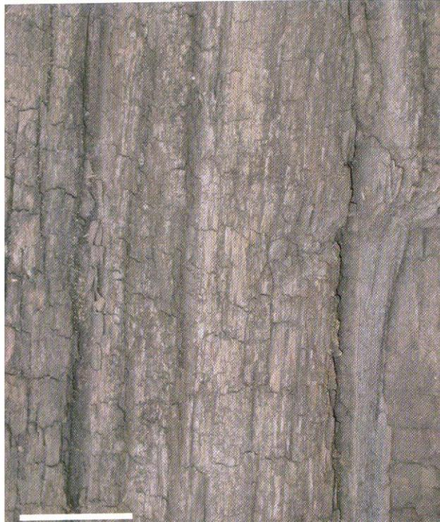
Abb. 25: Moderfäule an einem Wasserbauholz, das Holz ist querrissig, die feuchte Oberfläche schmierig und weich, Maßstab 5 cm, (HUCKFELDT, SCHMIDT, 2006)
