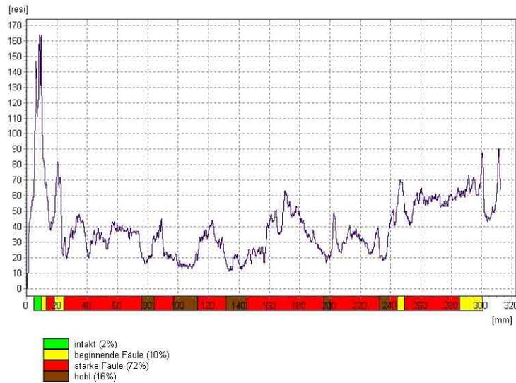
Abb. 152: Bohrung am eingelegten Kiefernholz (Querholz) des 5-jährigen Lärmschutzwalles im Irenental/NÖ, November 2008
