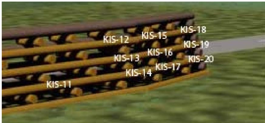
Abb. 134: Verteilung der Bohrungen KIS-11 bis 20 (Hinterseite), alle vertikal gebohrt, am 5-jährigen Lärmschutzwall im Irenental/NÖ
