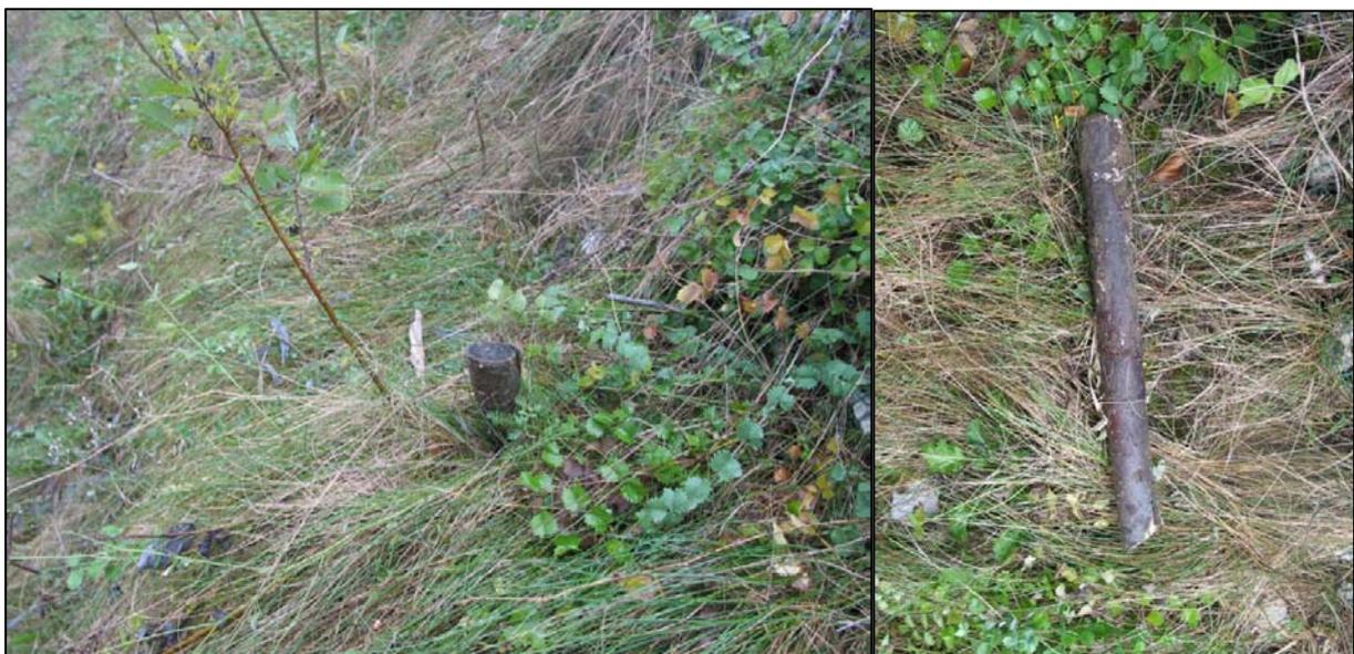
Abbildung 69: Steckhölzer: rechts ein spärlich angewachsenes, links ein totes Steckholz am Lawinenauffangdamm Steingrabenlawine, Bannwald Hallstatt, 10/2009
