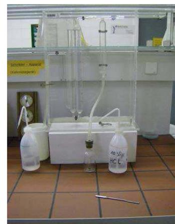
Abbildung 17: Scheiblerapparat zur Messung des Kalkgehaltes.
