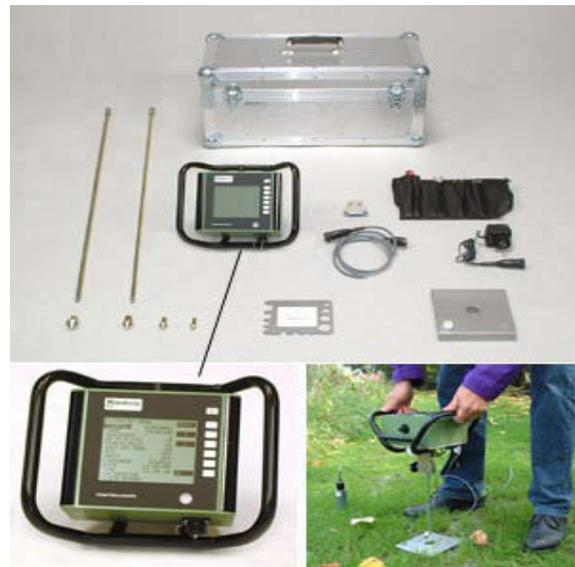
Abbildung 14: Penetrologger zur Messung der Bodendichte.
