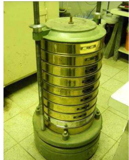
Abbildung 15: Siebturm für die Grobsiebung.
