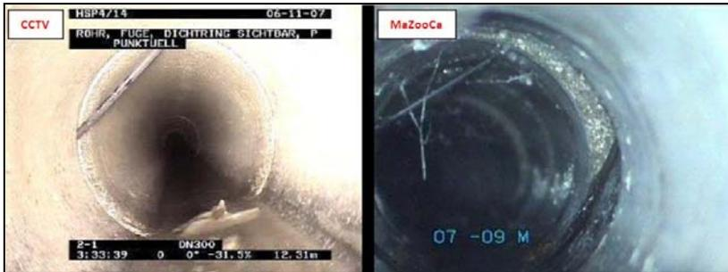
Abbildung 124 Distanzmessung TV - QuickView®, RF17-Dichtring sichtbar, Blindschacht (ERTL et al. 2010)
