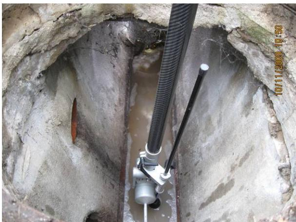
Abbildung 70 Schacht-Zoom-Kamera im Schacht
