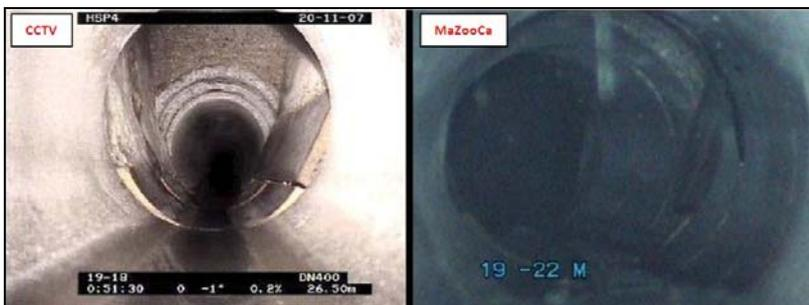
Abbildung 125 Distanzmessung TV - QuickView®, RE81-Blindschacht (ERTL et al. 2010)
