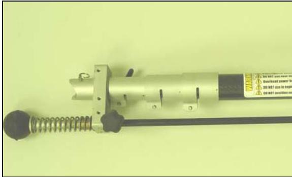
Abbildung 33 Teleskopstange mit gefedertem Abstandhalter (ENVIROSIGHT, 2010b)
