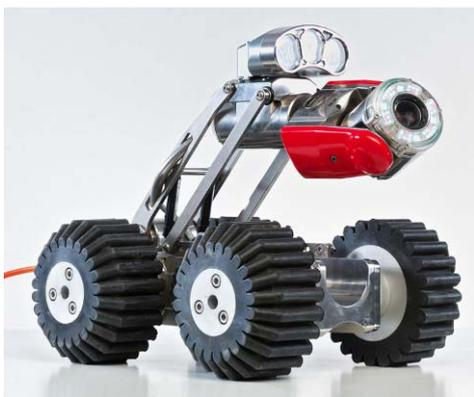
Abbildung 19 Fahrwagenkamera mit Dreh- Schwenkkopf (IPEK, 2010)
