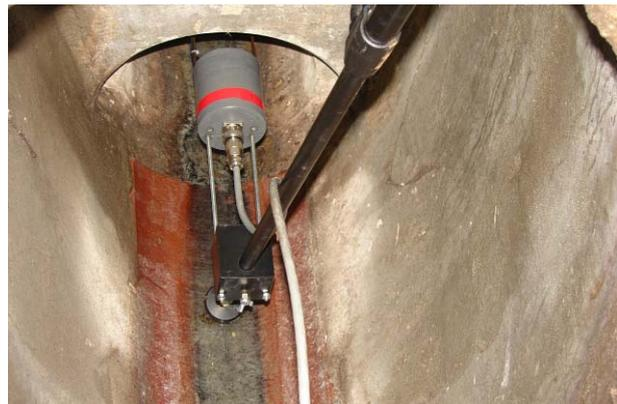
Abbildung 26 Akustischer Sensor im Schacht
