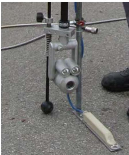
Abbildung 61 Schacht-Zoom-Kamera mit zusätzlich montierter Durchflussmesseinrichtung
