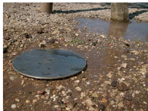
Abb. 11: Prallplatte für die Ermittlung der Wasserdurchlässigkeit (Wien, 2009)
