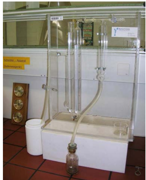
Abb. 10: Scheibler-Apparat zur Bestimmung des Kalkgehaltes (IBLB BOKU Wien, 2008)
