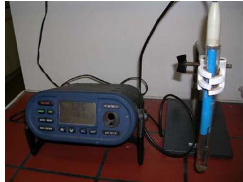
Abb. 9: Messgerät mit Elektrode zur Ermittlung des pH-Wertes (IBLB BOKU Wien, 2008)
