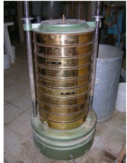
Abb. 17: Siebturm für die Grob- und Mittelsiebung (IGT BOKU Wien, 2010)
