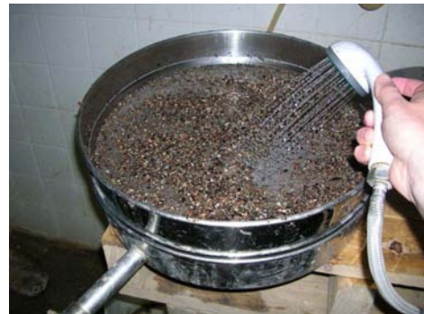
Abb. 15: Abtrennung des Feinanteils (IGT BOKU Wien, 2010)
