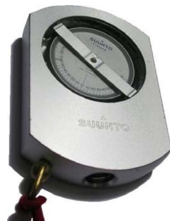
Abb. 8: Klinometer (Winkelmesser) für die Erhebung der Baumhöhe (Wien, 2010)
