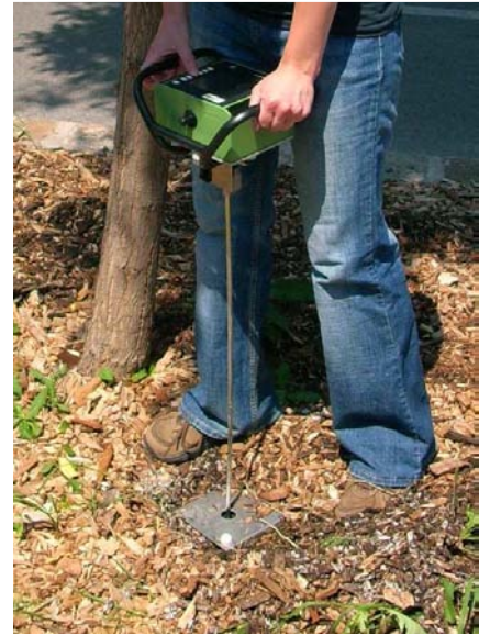
Abb. 14: Messung des Eindringwiderstandes in den Boden mithilfe des Penetrologgers (Wien, 2009)
