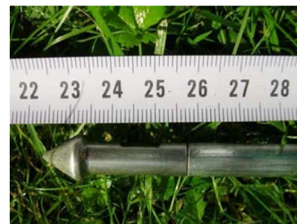
Abb. 13: Konus als Spitze der Sondierstange des Penetrologgers (IBLB BOKU Wien, 2009)
