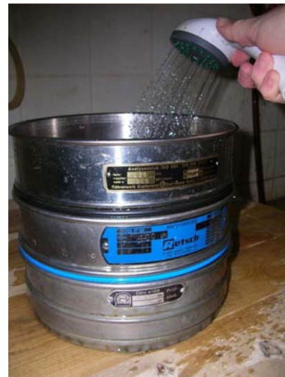
Abb. 16: Schlämzung des Feinanteils durch drei Siebe unterschiedlicher Maschenweite (IGT BOKU Wien, 2010)
